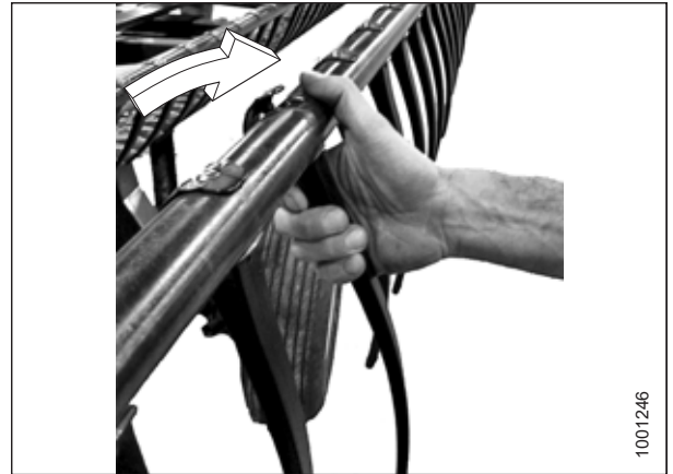
Abbildung 4.276: Einbauen eines Kunststoffhaspelfingers
