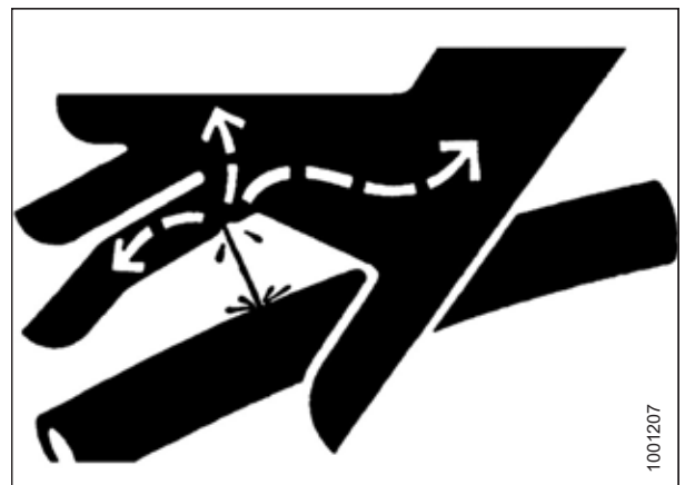
Abbildung 1.12: Gefährdung durch Hydraulikdruck
