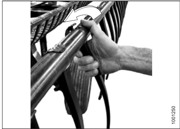
Abbildung 4.275: Ausbauen eines Kunststoffhaspelfingers
