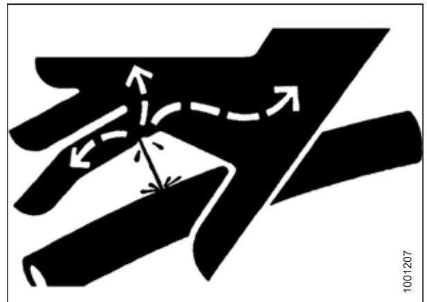
Abbildung 4.1: Gefährdung durch Hydraulikdruck
