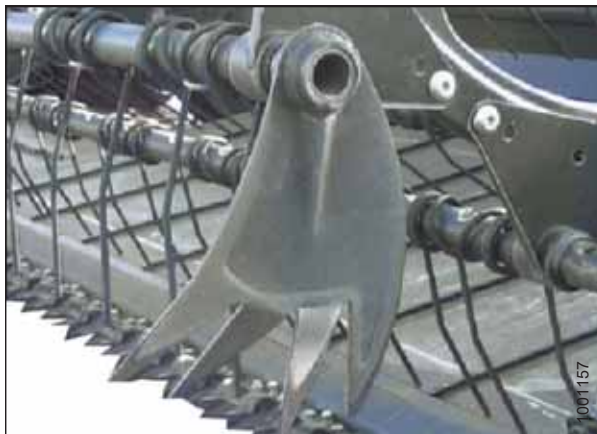
Abbildung 5.6: Haspelfinger für liegendes Erntegut
