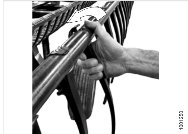
Abbildung 4.275: Ausbauen eines Kunststoffhaspelfingers
