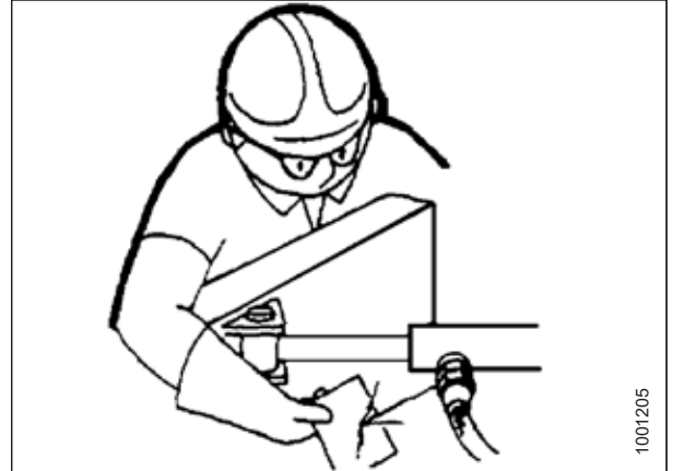
Abbildung 1.11: Suche nach undichten Hydraulikstellen
