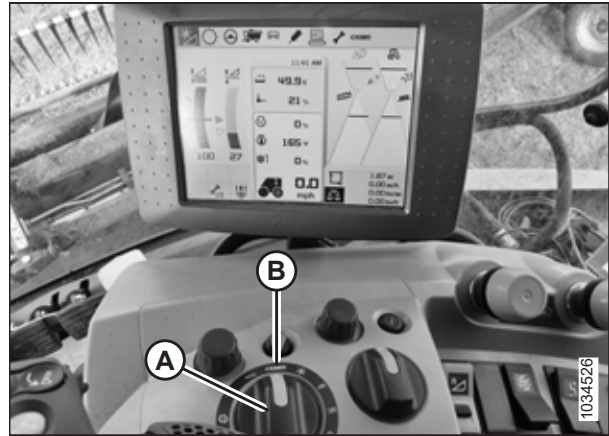
Abbildung 3.64: Position des CEBIS-Wahlschalters zur Steuerung der Seitenbandgeschwindigkeit
