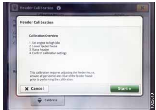
Abbildung 3.799: Display John Deere S700 – Schneidwerkskalibrierung
