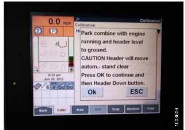
Abbildung 3.505: Display auf New Holland Mähreschern
