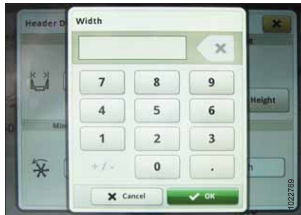
Abbildung 3.469: Display John Deere S7 – Einstellung Schneidwerksbreite
