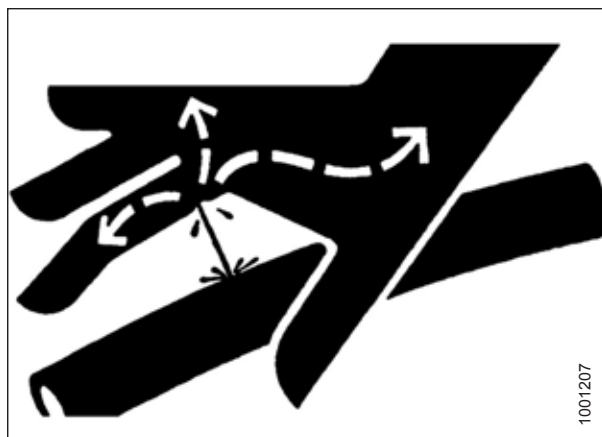
Abbildung 5.1: Gefährdung durch Hydraulikdruck
