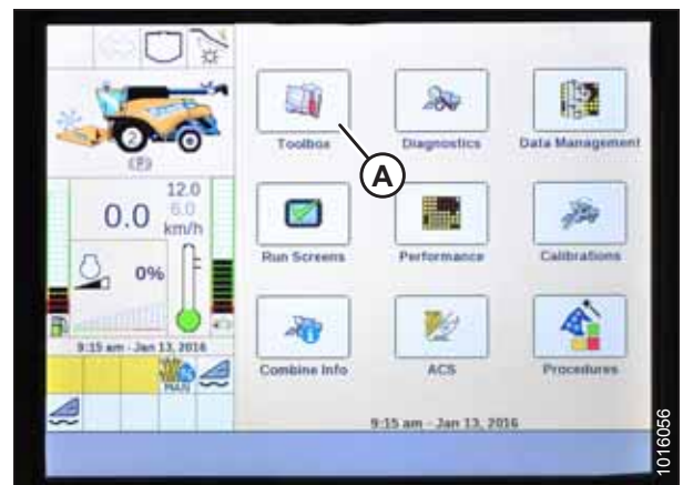
Abbildung 3.520: Display auf New Holland Mähdreschern
