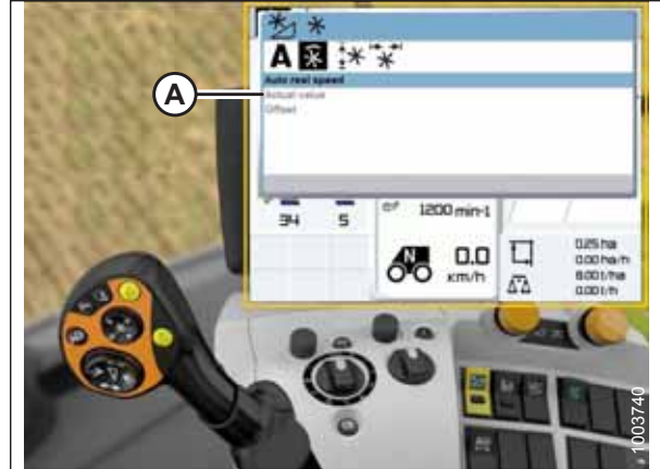
Abbildung 3.325: Display, Bedienkonsole und Multifunktionshebel des CLAAS Mähreschers
