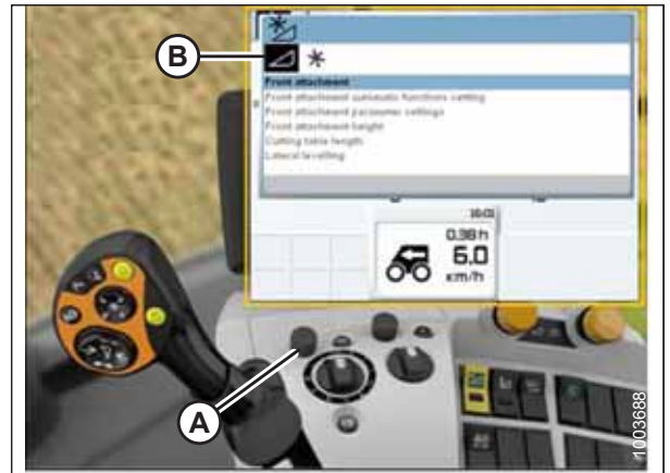
Abbildung 3.314: Display, Bedienkonsole und Multifunktionshebel des CLAAS Mähdreschers
