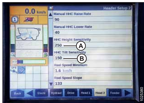
Abbildung 3.227: Bildschirmanzeige des Case IH
