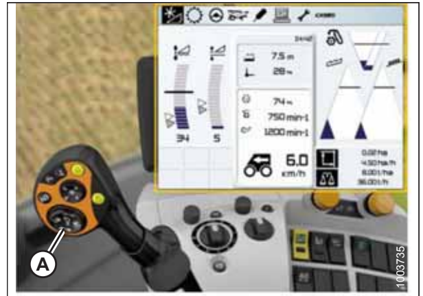
Abbildung 3.319: Display, Bedienkonsole und Multifunktionshebel des CLAAS Mähreschers
