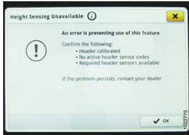
Abbildung 3.475: Display John Deere S7 – Fehlermeldung Höhenerkennung
