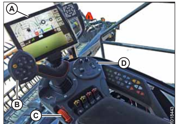
Abbildung 3.397: Bedienelemente Gleaner S9
