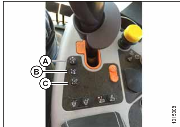
Abbildung 3.537: Bedienelemente eines New Holland Mähdreschers
