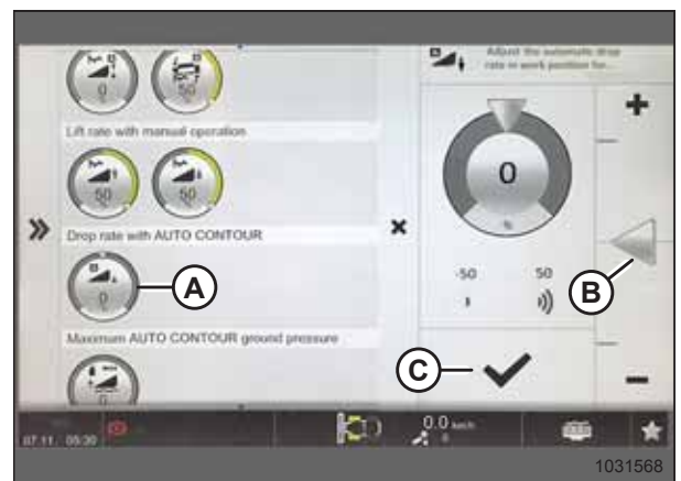
Abbildung 3.349: Auswahl „Absenkgeschwindigkeit bei automatischer Konturführung“
