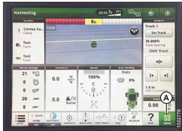
Abbildung 3.489: Display John Deere S7 – Ernte-Bildschirm
