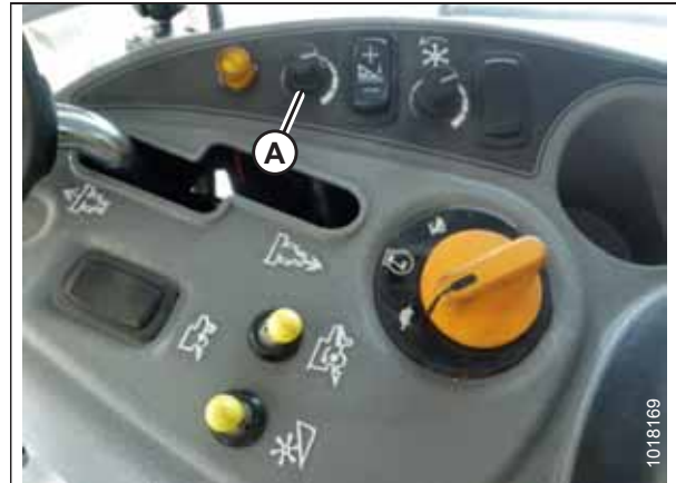
Abbildung 3.287: Schneidwerkshöhe-Drehknopf auf der Bedienkonsole
