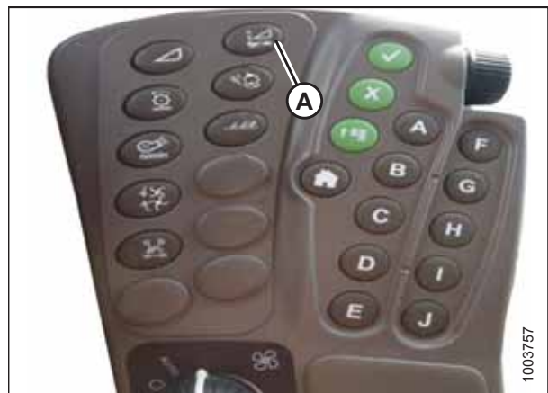
Abbildung 3.427: Bedienkonsole Command Center auf John Deere Mähdreschern
