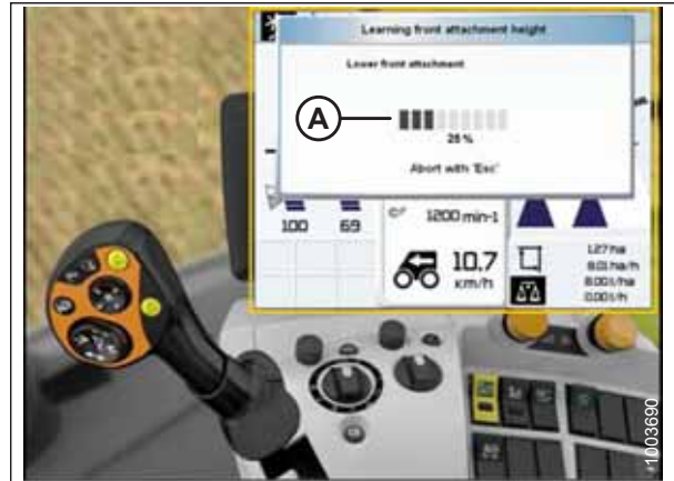
Abbildung 3.331: Display, Bedienkonsole und Multifunktionshebel des CLAAS Mähreschers
