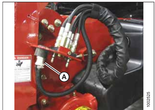
Abbildung 4.99: Multikuppler am Mähdrescher
