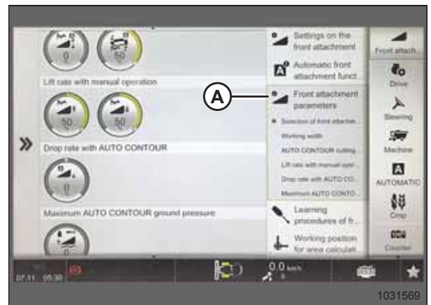
Abbildung 3.348: Seite „Parameter Vorsatzgerät“
