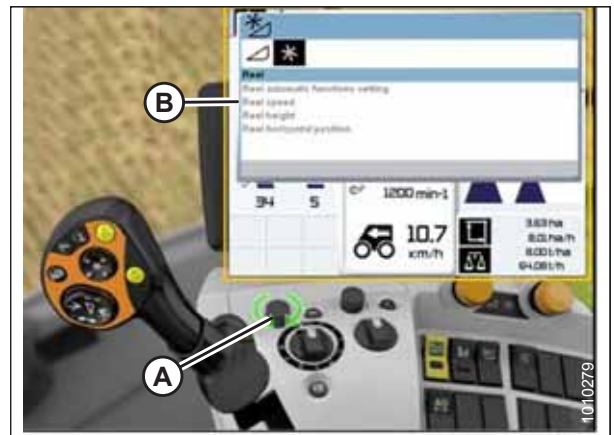
Abbildung 3.324: Display, Bedienkonsole und Multifunktionshebel des CLAAS Mähreschers
