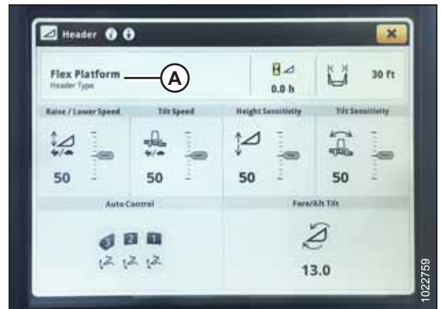
Abbildung 3.467: Display John Deere S7 – Schneidwerk-Seite
