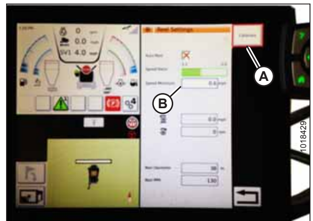
Abbildung 3.381: Kalibrieren der Haspeleinstellungen
