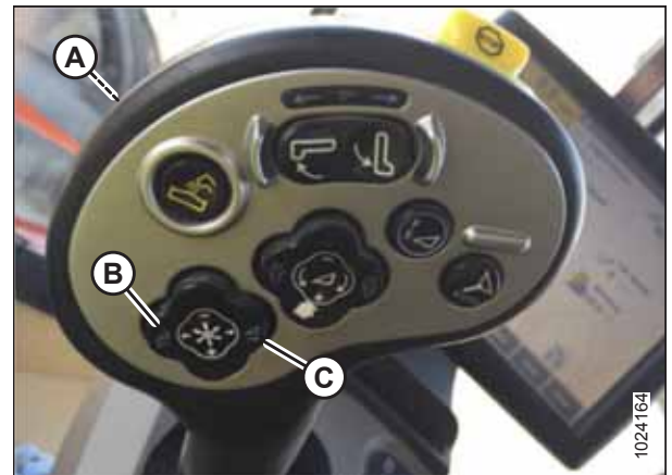
Abbildung 3.103: Bedienpult eines Case-Mähdreschers
