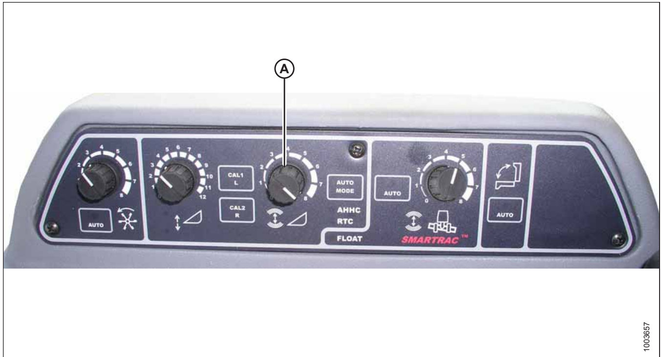
Abbildung 3.367: Bedienkonsole der automatischen Schneidwerkshöhenregulierung (AHHC)
