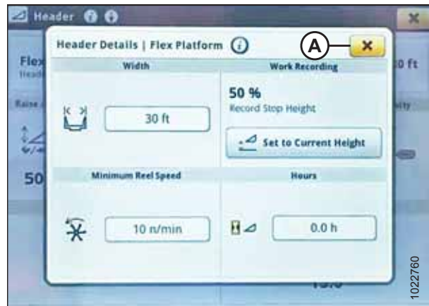
Abbildung 3.470: Display John Deere S7 – Bildschirm mit Schneidwerksangaben
