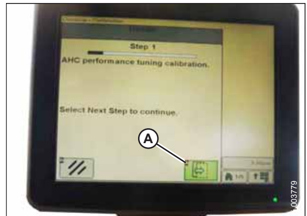
Abbildung 3.436: Display auf John Deere Mähreschern
