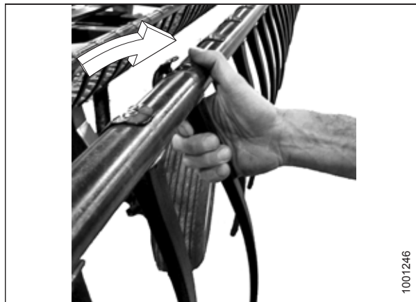
Abbildung 5.315: Einbauen eines Kunststoffhaspelfingers
