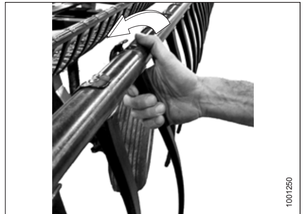
Abbildung 5.314: Ausbauen eines Kunststoffhaspelfingers
