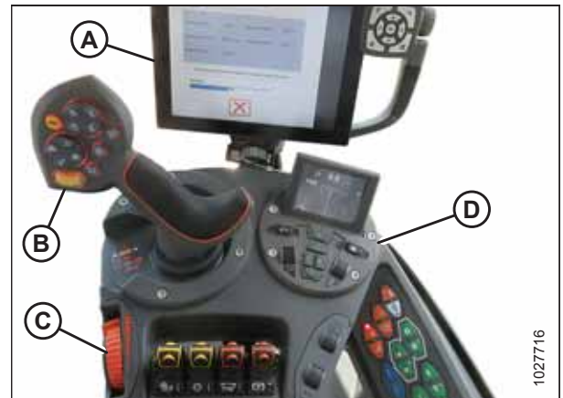
Abbildung 3.195: Bedienkonsole AGCO IDEAL™
