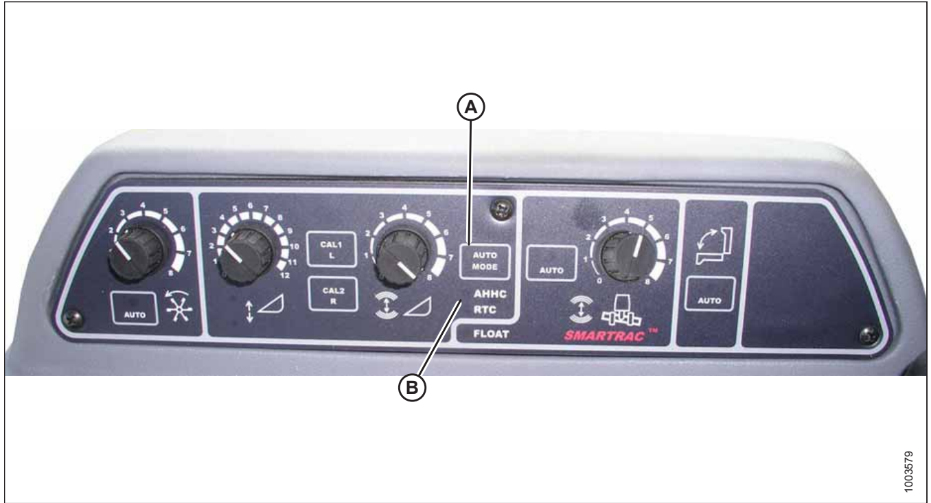
Abbildung 3.360: Bedienelemente für automatische Schneidwerkshöhenregulierung (AHHC)
