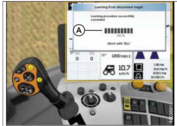
Abbildung 3.332: Display, Bedienkonsole und Multifunktionshebel des CLAAS Mähreschers
