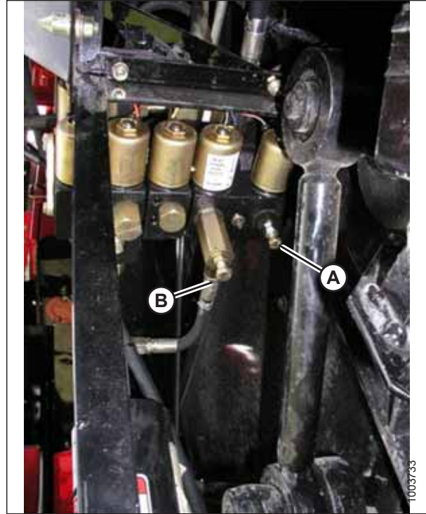
Abbildung 3.364: Einstellbare Drosselventile für Anhub/Absenken des Schneidwerks
