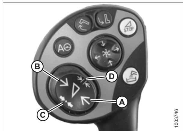
Abbildung 3.301: Tasten auf Multifunktionshebel
