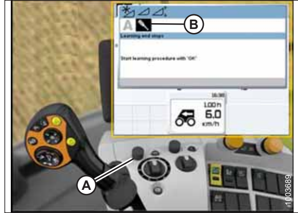
Abbildung 3.330: Display, Bedienkonsole und Multifunktionshebel des CLAAS Mähreschers
