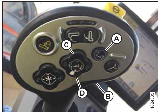
Abbildung 3.275: Bedienpult eines Case-Mähdreschers
