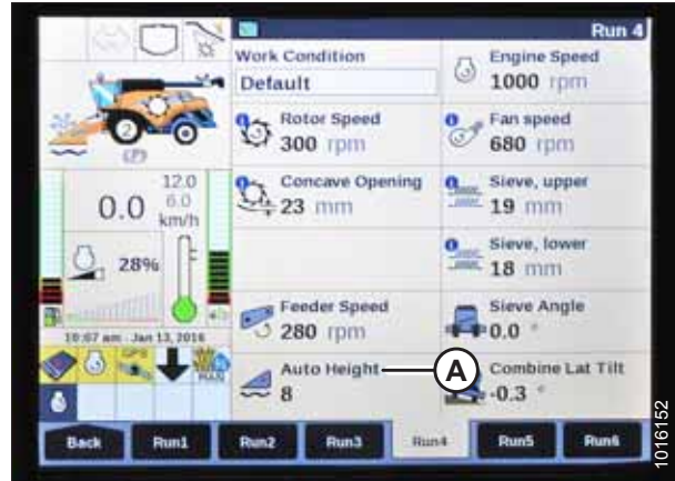
Abbildung 3.541: Display auf New Holland Mähreschern
