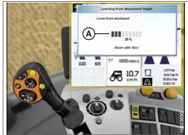
Abbildung 3.317: Display, Bedienkonsole und Multifunktionshebel des CLAAS Mähdreschers
