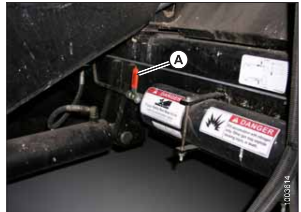
Abbildung 3.363: Absperrhebel für Druckspeicher
