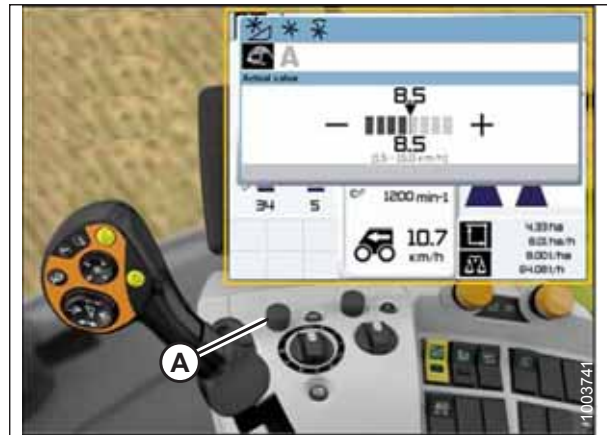
Abbildung 3.326: Display, Bedienkonsole und Multifunktionshebel des CLAAS Mähreschers
