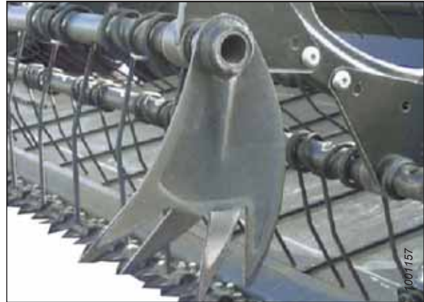
Figure 5.6: Griffe de rabatteur pour récolte couchée
