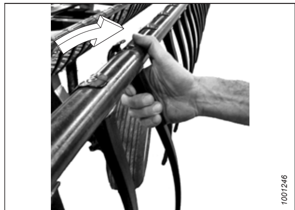
Figure 4.281: Installation des doigts en plastique
