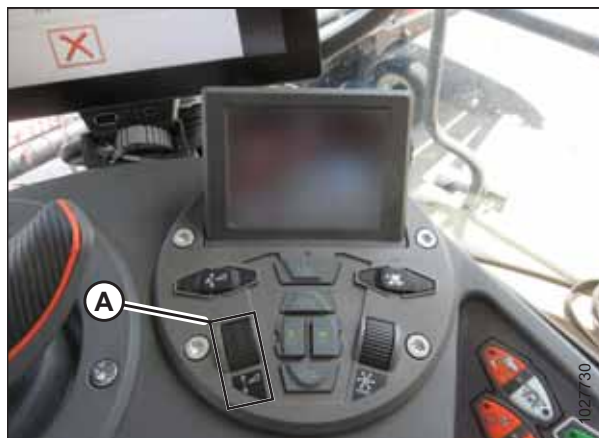
Figure 3.698: Groupe de commande de la plateforme
