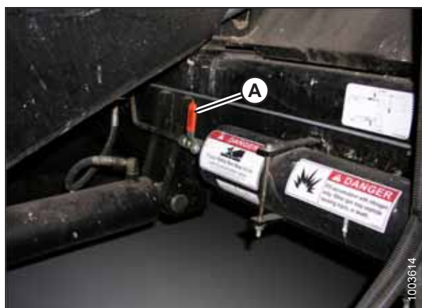
Figure 3.622: Commutateur ON/OFF (marche/arrêt) de l'accumulateur de la moissonneuse-batteuse A – Levier de l'accumulateur (position Off)
