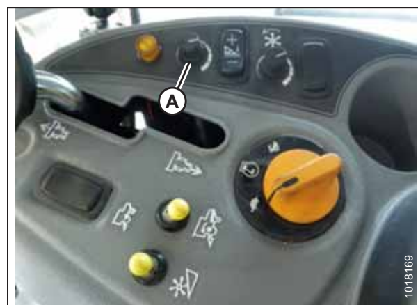
Figure 3.534: Bouton de réglage de la hauteur sur la console de commande de la moissonneuse-batteuse
