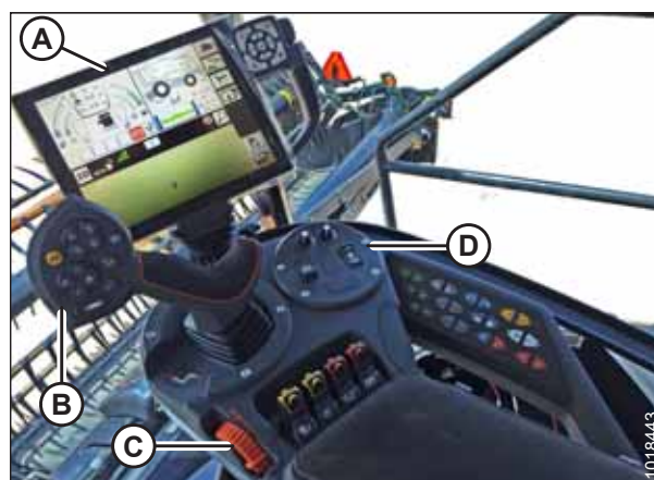
Figure 3.629: Poste de l'opérateur – Gleaner MD S9 A - Terminal Tyton B - Poignée de commande C - Manette des gaz D - Clavier de commande de la plateforme
