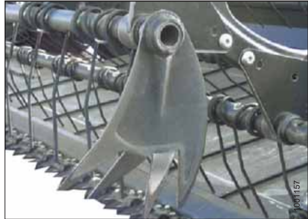
Figure 5.6: Griffe de rabatteur pour récolte couchée
