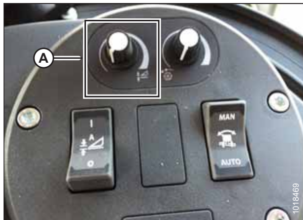
Figure 3.662: Groupe de commande de la plateforme
