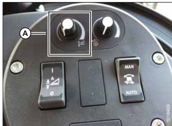
Figure 3.665: Groupe de commande de la plateforme
