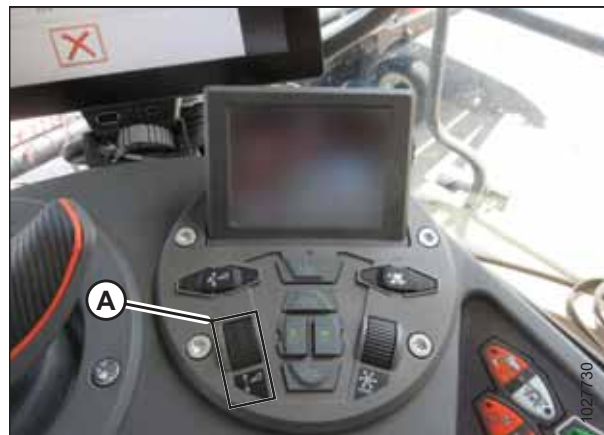
Figure 3.695: Groupe de commande de la plateforme
