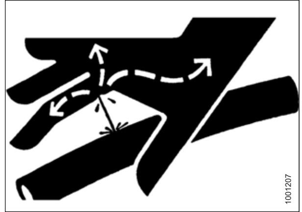
Figure 4.1: Hüdraulikarõhuga seotud oht
