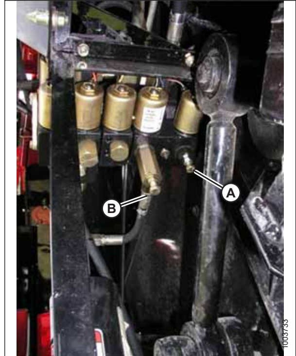
Figure 3.623: Heedri tõstmise ja langetamise reguleeritavad piirajad
