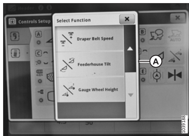
Figure 3.76: John Deere'i X9 ekraan – juhtseadete seadistamine
