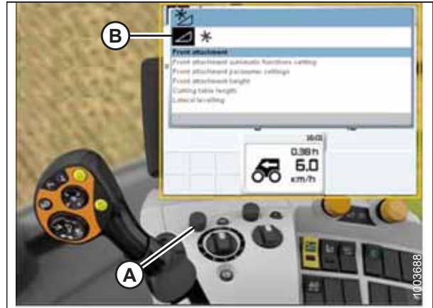
Figure 3.565: CLAAS Lexioni kombaini ekraan, konsool ja juhtseadme käepide
