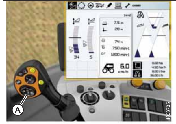
Figure 3.570: CLAAS Lexioni kombaini ekraan, konsool ja juhtseadme käepide
