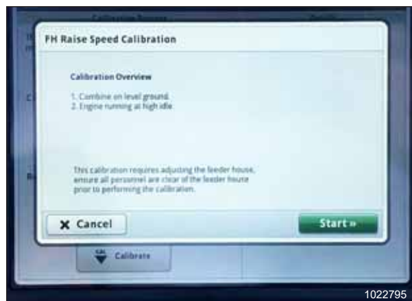
Figure 3.789: John Deere S700 ekraan – söötekorpuse kalibreerimine
