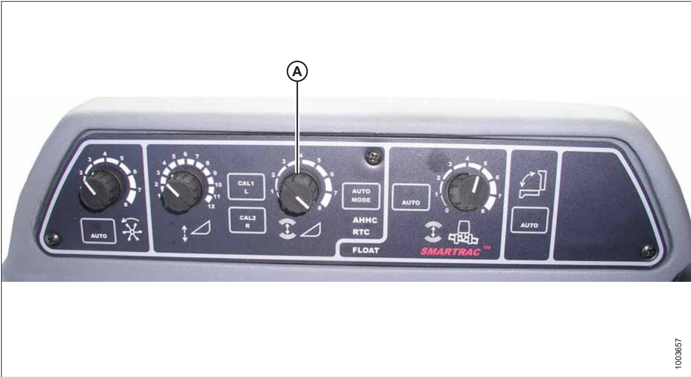
Figure 3.626: Heedri kõrguse automaatjuhtimise konsool
