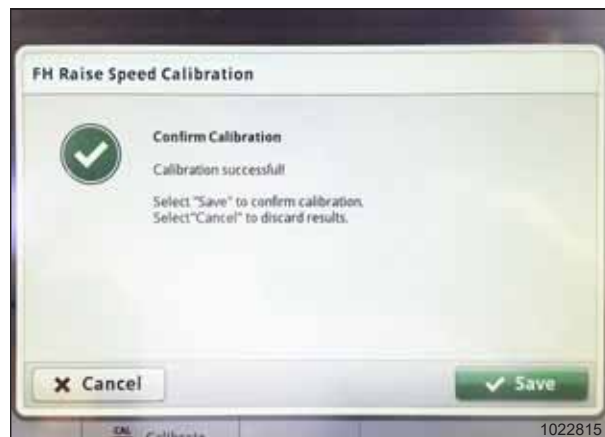
Figure 3.791: John Deere S700 ekraan – söötekorpuse kalibreerimine
