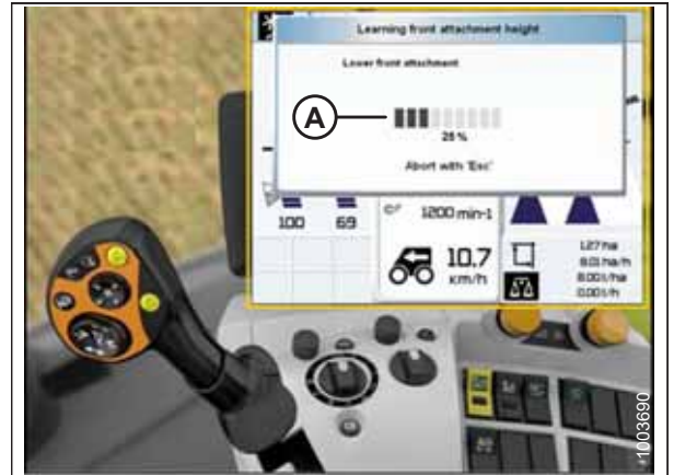
Figure 3.568: CLAAS Lexioni kombaini ekraan, konsool ja juhtseadme käepide
