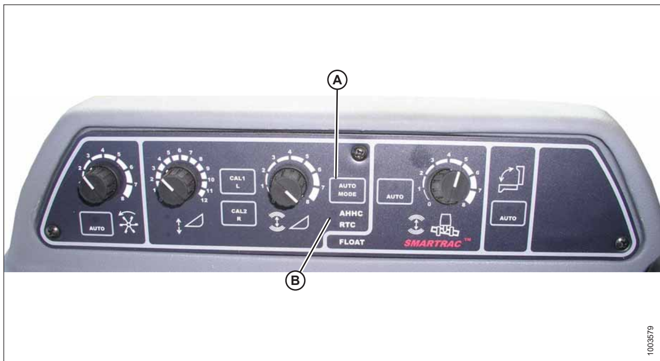
Figure 3.617: Kombainiheedri automaatse kõrguse juhtseadised
