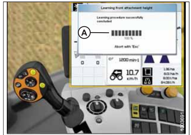
Figure 3.569: CLAAS Lexioni kombaini ekraan, konsool ja juhtseadme käepide
