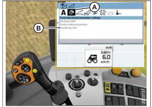
Figure 3.572: CLAAS Lexioni kombaini ekraan, konsool ja juhtseadme käepide
