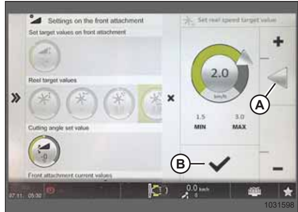
Figure 3.607: Trumli kiiruse sihtväärtuse lehekülg
