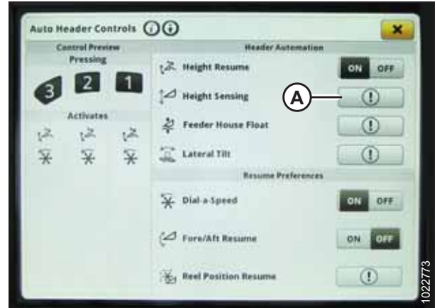
Figure 3.777: John Deere S700 ekraan – heedri automaatsed juhtseadmed
