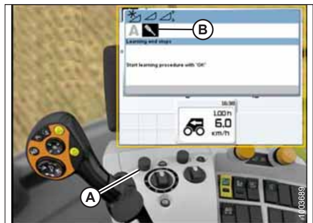
Figure 3.567: CLAAS Lexioni kombaini ekraan, konsool ja juhtseadme käepide
