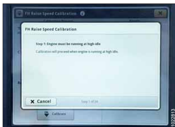
Figure 3.790: John Deere S700 ekraan – söötekorpuse kalibreerimine
