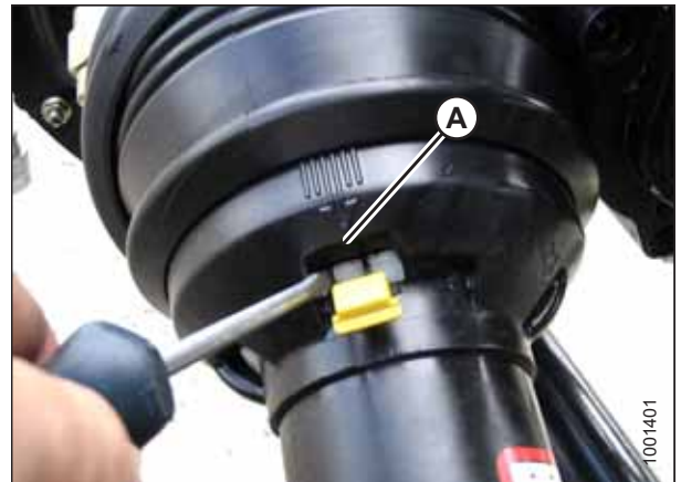
Figura 4.59: Apărătoarea liniei de transmisie
