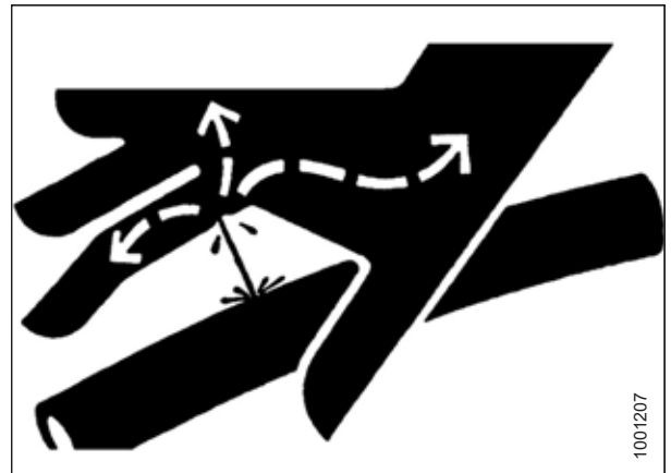
Figura 4.1: Pericolul presiunii hidraulice
