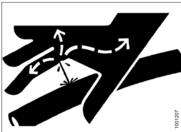
Figura 1.12: Pericolul presiunii hidraulice
