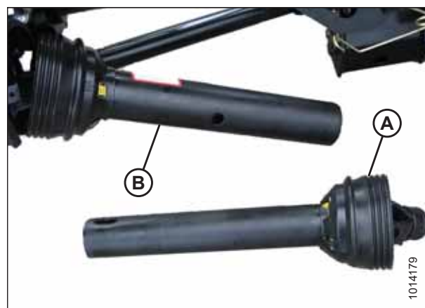
Figura 4.54: Linie de transmisie separată
