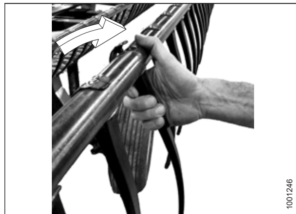
Figura 4.276: Montarea degetului din plastic
