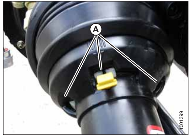
Figura 4.58: Apărătoarea liniei de transmisie
