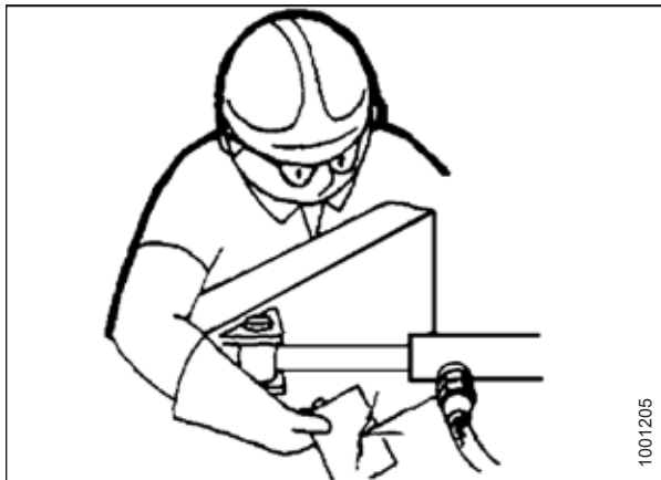
Figura 1.11: Testarea pentru scurgeri hidraulice
