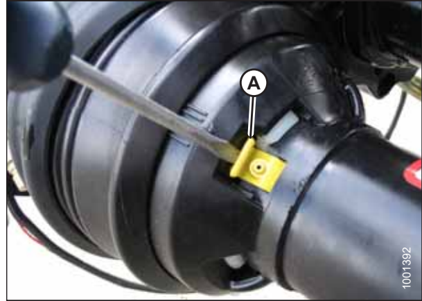
Figura 4.55: Apărătoarea liniei de transmisie
