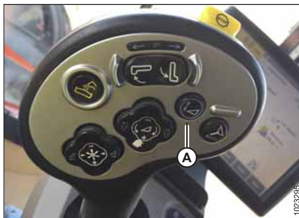
Figura 3.292: Maneta de comandă a combinei Case
