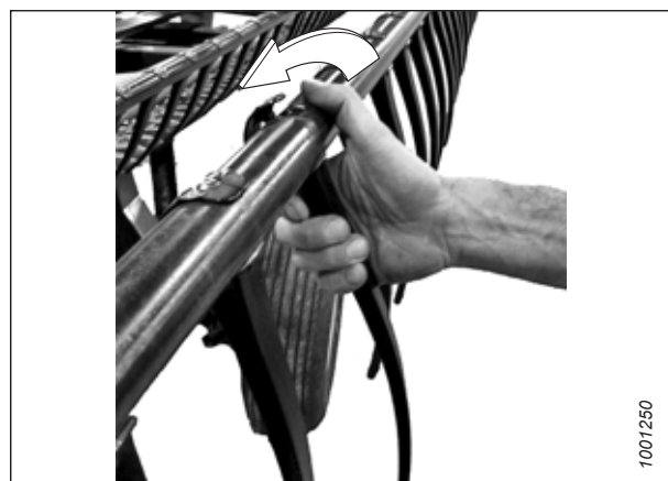
Abbildung 4.293: Ausbauen eines Kunststoffhaspelfingers
