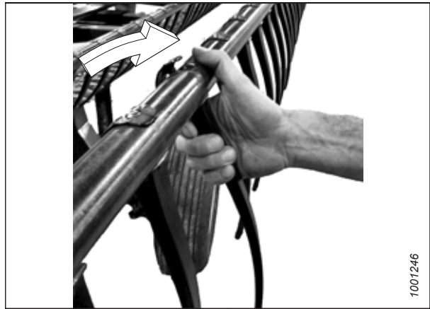
Abbildung 4.294: Einbauen eines Kunststoffhaspelfingers
