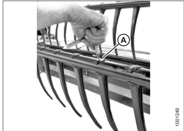
Фигура 4.274: Отстраняване на пластмасов зъб
