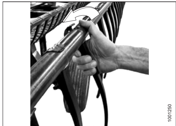
Фигура 4.275: Отстраняване на пластмасов зъб
