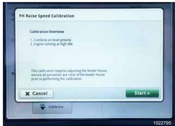
Фигура 3.789: Дисплей на John Deere S700 – Калибриране на подаващата камера
