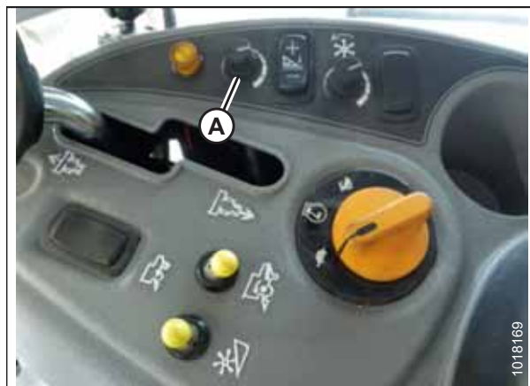
Фигура 3.534: Ръкохватка за регулиране на височината на конзолата за управление на комбайна
