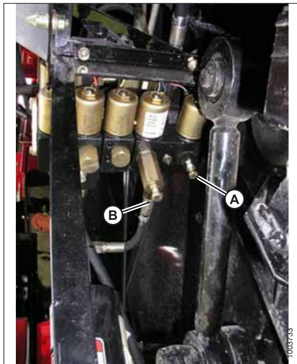
Фигура 3.623: Регулируеми ограничители за вдигане и спускане на хедера
