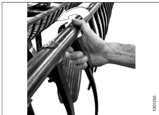
Фигура 4.275: Отстраняване на пластмасов зъб
