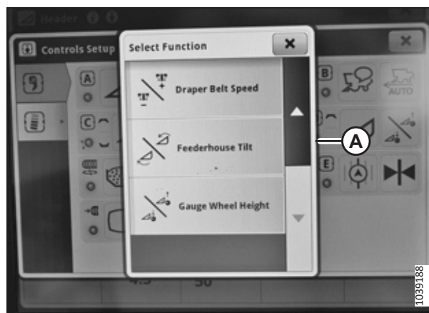
Фигура 3.76: Дисплей John Deere X9 – Настройка на органите за управление
