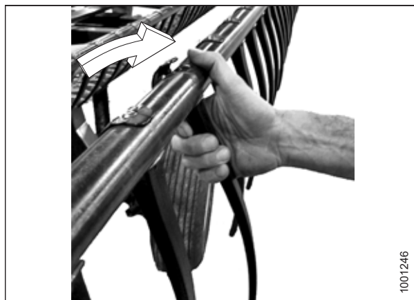
Obrázek 4.276: Montáž plastového prstu
