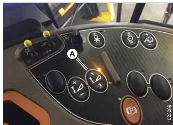
Obrázek 3.289: Ovládací panel sklízecí mlátičky Case
