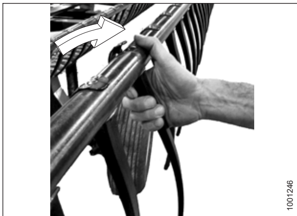
Obrázek 4.276: Montáž plastového prstu
