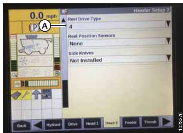
Obrázek 3.282: Displej sklízecí mlátičky Case IH
