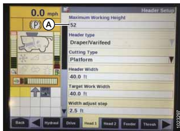
Obrázek 3.293: Displej sklízecí mlátičky Case – stránka Header Setup (nastavení adaptéru)
