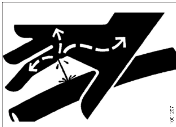
Obrázek 4.1: Nebezpečí tlaku v hydraulice
