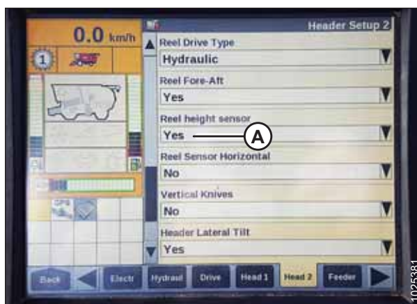
Obrázek 3.321: Displej sklízecí mlátičky Case IH
