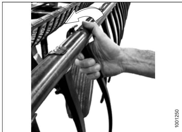
Obrázek 4.275: Demontáž plastového prstu
