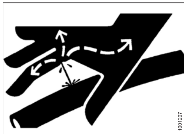
Obrázek 1.12: Nebezpečí tlaku v hydraulice
