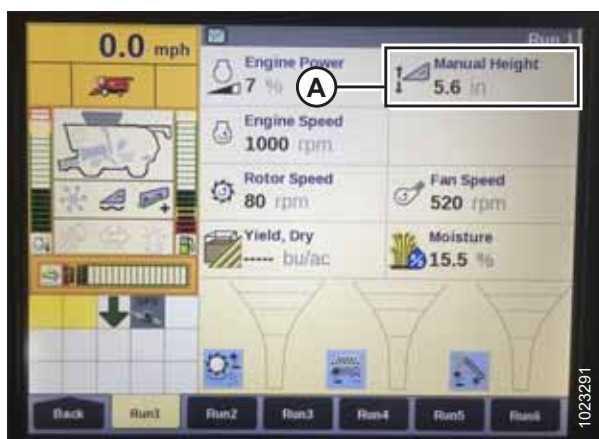
Obrázek 3.291: Displej sklízecí mlátičky Case – stránka Run 1
