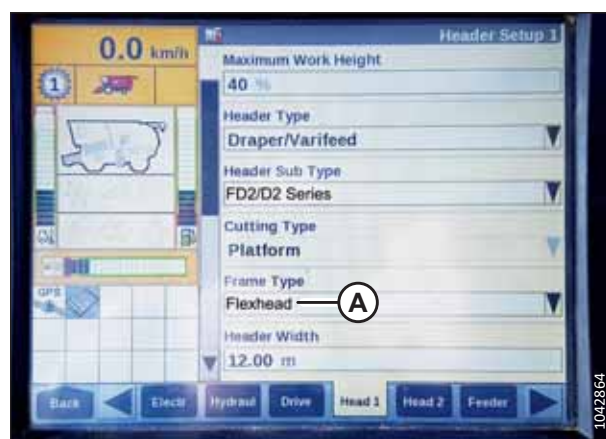
Obrázek 3.47: Displej sklízecí mlátičky Case IH
