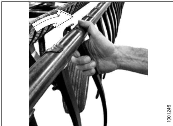
Figur 4.297: Installation av haspelfingrar av plast
