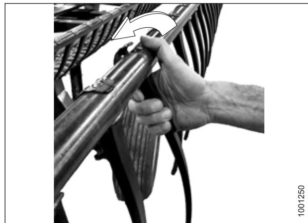
Figur 4.296: Borttagning av haspelfingrar av plast
