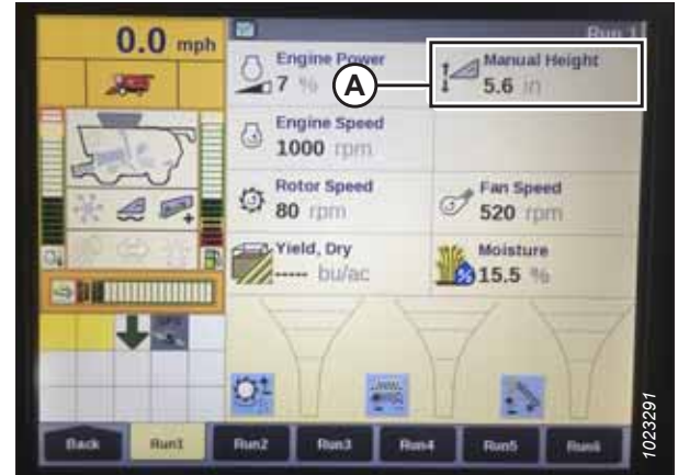
Фигура 3.276: Дисплей на комбайни Case – страница Run 1 (Изпълнение 1)
