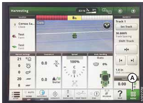
pav. 3.754: „John Deere“ S7 ekranas – derliaus nuėmimo puslapis
