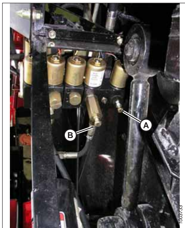
pav. 3.604: Pjaunamosios pakėlimo ir nuleidimo reguliuojami ribotuvai
