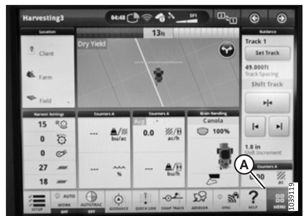
pav. 3.796: „John Deere“ X9 ekranas – puslapis „Harvesting“ (derliaus nuėmimas)
