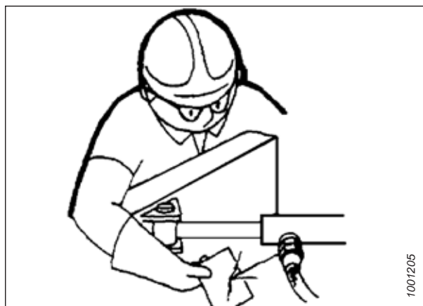
pav. 4.2: Hidraulinių nuotėkių tikrinimas
