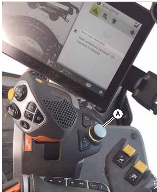
pav. 3.595: Operatoriaus valdikliai
