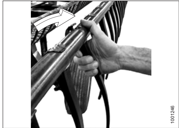
Figure 4.276: Installation des doigts en plastique
