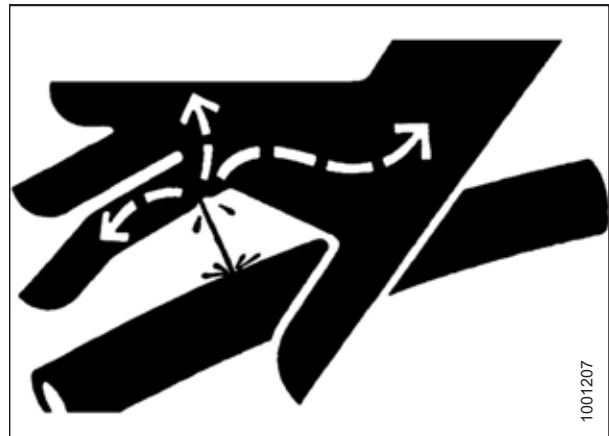
Figure 1.12: Risque lié à la pression hydraulique
