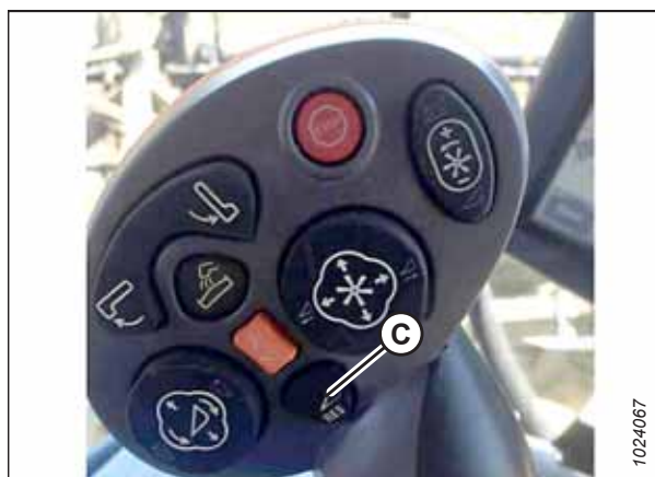
Figure 3.358: New Holland-mejetærsker multifunktionshåndtag
