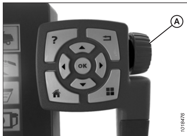
Figur 3.646: Justeringshjul til højre på Tyton-terminal
