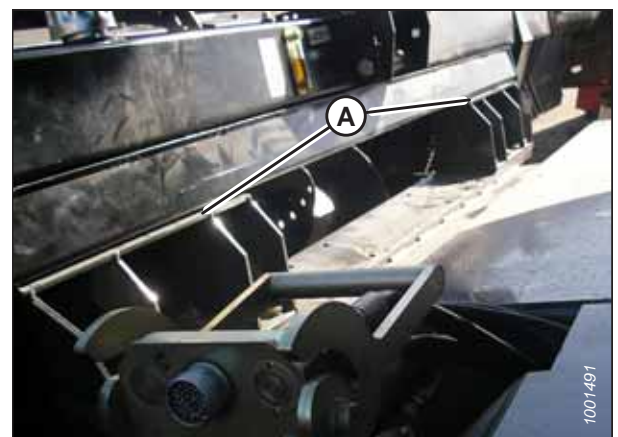
Figur 3.53: Indføringshus og flydemodul
