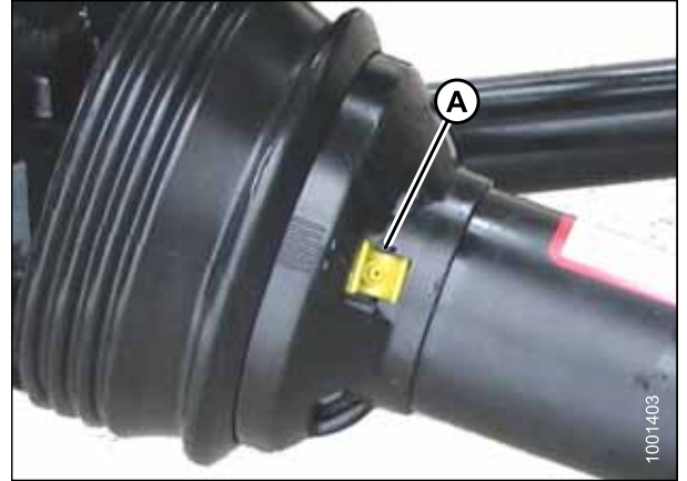
Figura 5.43: Proteção do eixo de transmissão
