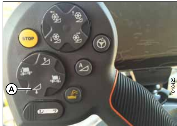
Figura 3.280: Interruptor de descida da plataforma
