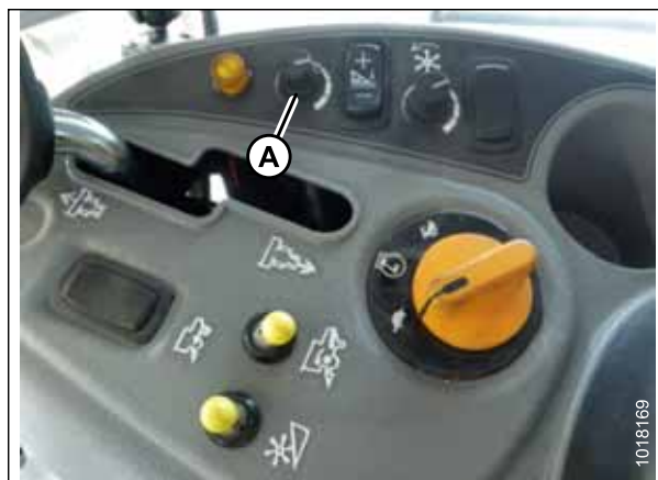
Figura 3.240: Botão de ajuste de altura no console de controle da colheitadeira
