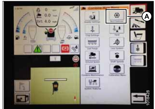
Figura 3.269: Configurações do molinete no menu principal da colheitadeira
