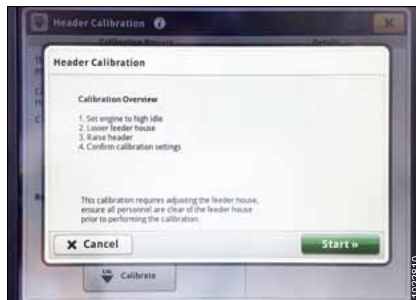
Figura 3.391: Monitor John Deere S7 – Calibração da plataforma
