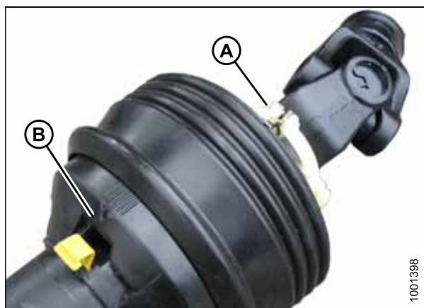
Figura 5.40: Proteção do eixo de transmissão
