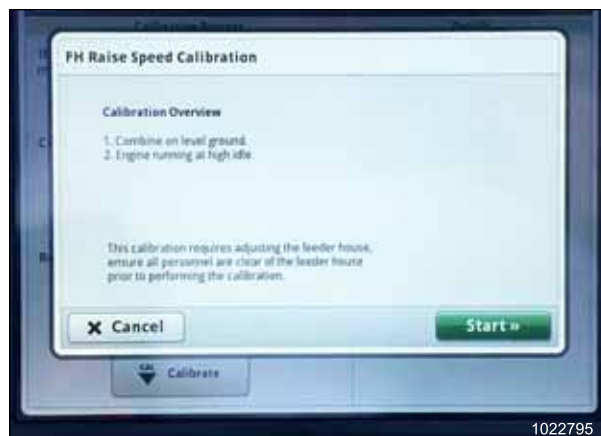
Figura 3.383: Monitor John Deere S7 – Calibração do alimentador
