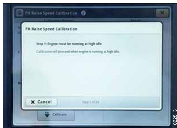
Figura 3.384: Monitor John Deere S7 – Calibração do alimentador
