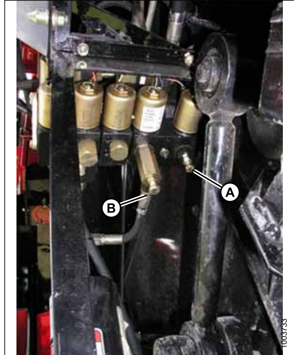
Figura 3.253: Restritores ajustáveis de elevação e descida da plataforma
