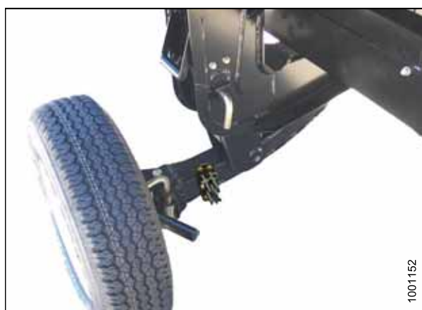
Figura 3.502: Roda esquerda em posição de transporte
