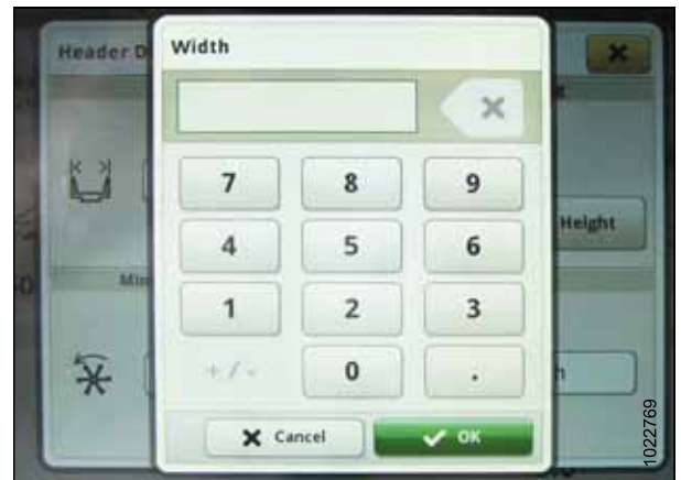
Figura 3.366: Monitor John Deere S7 – Ajuste de largura da plataforma
