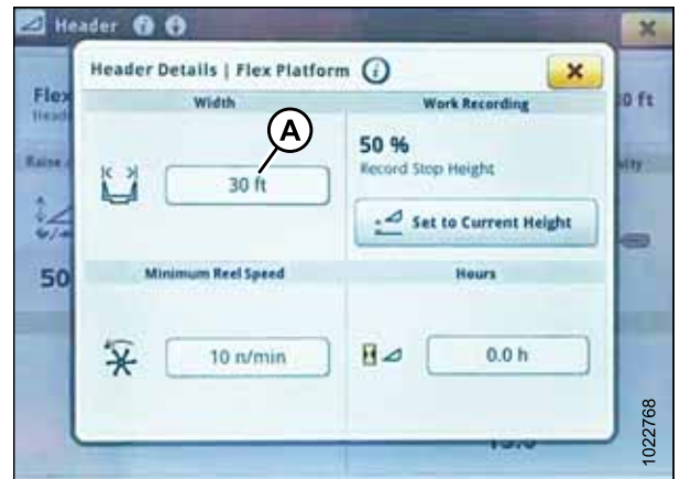
Figura 3.365: Monitor John Deere S7 – Janela de detalhes da plataforma
