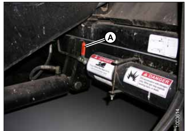
Figura 3.252: Interruptor Ligar/Desligar do acumulador da colheitadeira
