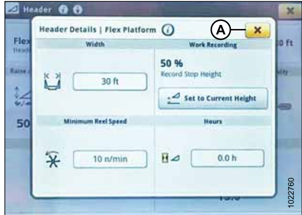
Figura 3.367: Monitor John Deere S7 – Janela de detalhes da plataforma
