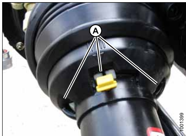
Figura 5.41: Proteção do eixo de transmissão
