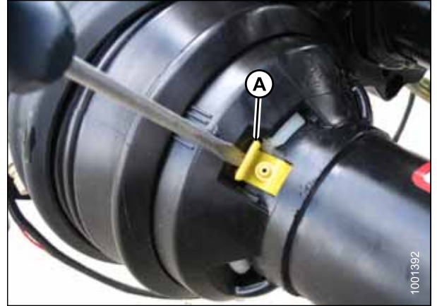
Figura 5.38: Proteção do eixo de transmissão
