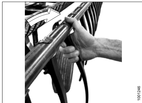
Figura 5.220: Instalação do dedo de plástico
