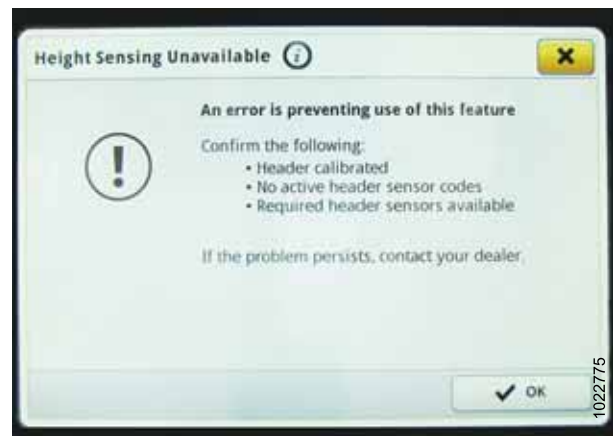
Figura 3.372: Monitor John Deere S7 – Mensagem de erro do sensor de altura
