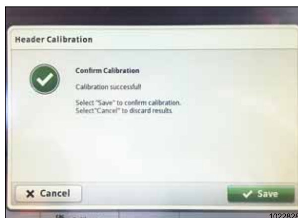
Figura 3.392: Monitor John Deere S7 – Calibração da plataforma
