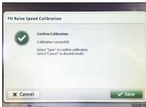
Figura 3.385: Monitor John Deere S7 – Calibração do alimentador
