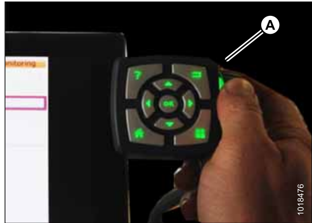
Figura 3.291: Roda de ajuste no lado direito do terminal Tyton
