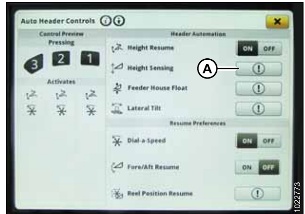
Figura 3.371: Monitor John Deere S7 – Controle automático da plataforma
