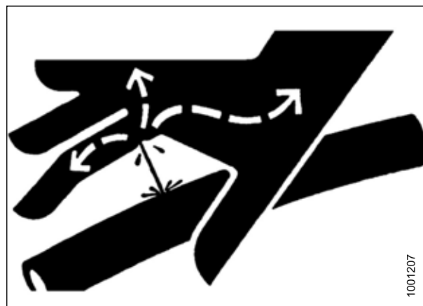
Figura 5.2: Perigo da pressão hidráulica
