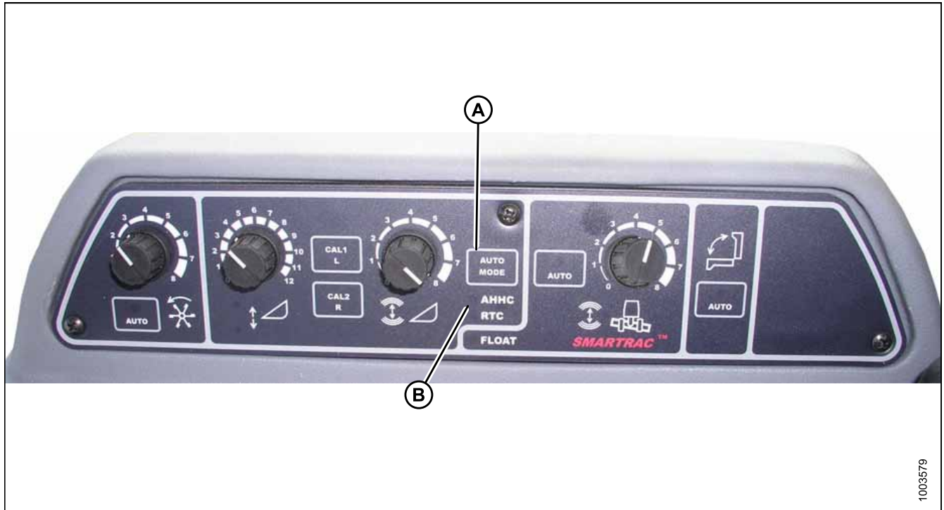
Figura 3.249: Controles de altura automática da plataforma da colheitadeira
