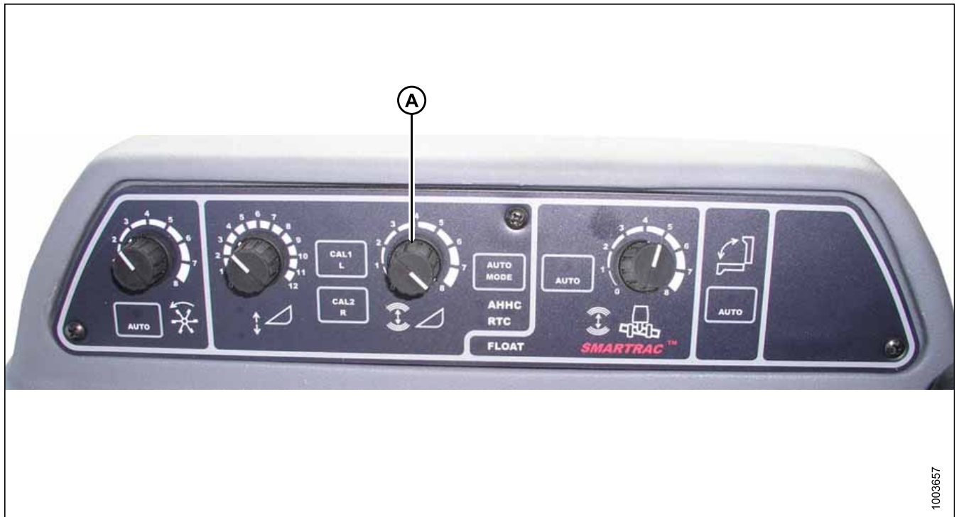
Figura 3.256: Console de controle de altura automática da plataforma
