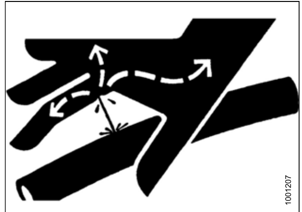
Abbildung 5.2: Gefährdung durch Hydraulikdruck
