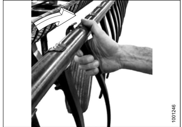
Abbildung 5.228: Einbauen eines Kunststoffhaspelfingers
