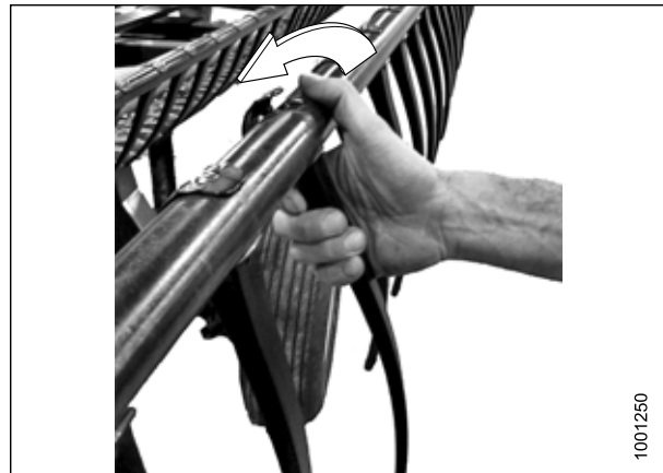
Abbildung 5.227: Ausbauen eines Kunststoffhaspelfingers
