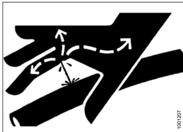
Рисунок 5.3: Опасное давление гидравлической жидкости
