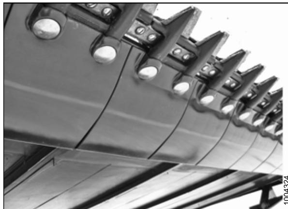
Рисунок 6.6: Износные пластины ножевого бруса
