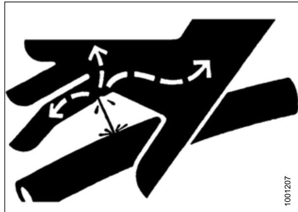
Рисунок 1.12: Опасное давление гидравлической жидкости
