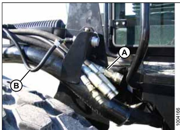
Рисунок 4.1: Шланги привода жатки
