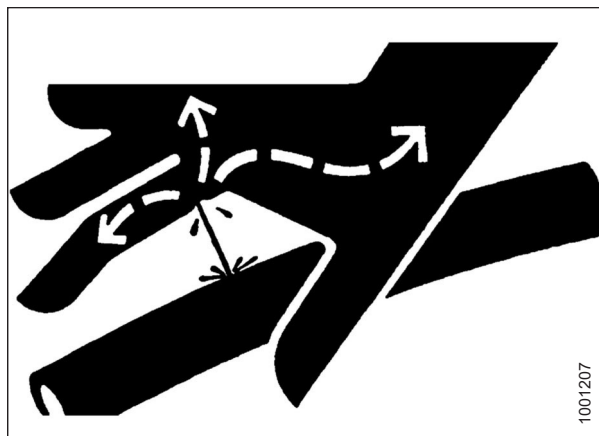
Рисунок 5.1: Опасное давление гидравлической жидкости
