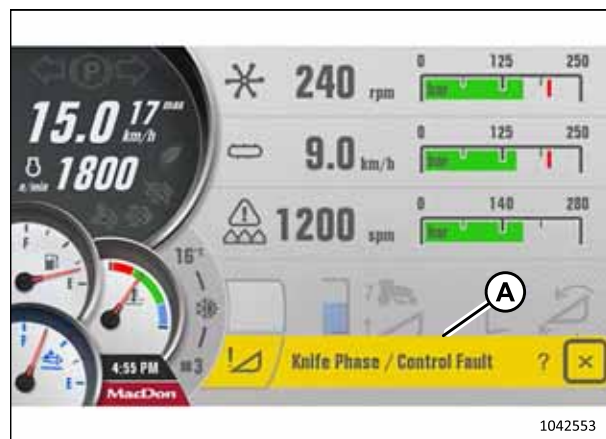
Figure 5.25: Défaut du couteau d'ETDK
