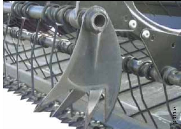
Figure 6.6: Griffe de rabatteur pour récolte couchée
