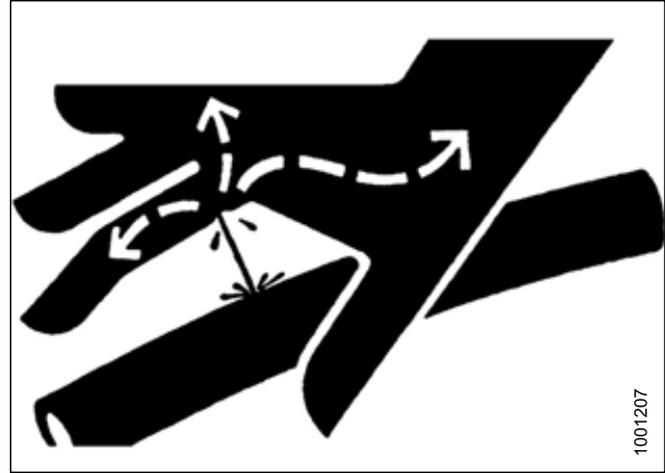
Figure 5.1: Risque lié à la pression hydraulique
