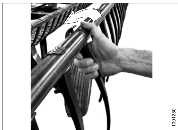
Figur 5.149: Fjerner pig af plastik
