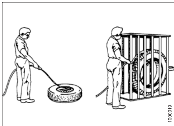
Figur 1.15: Sikker oppumpning af dæk
