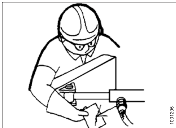
Рисунок 4.2: Проверка наличия гидравлических течей
