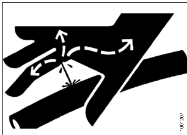
Рисунок 4.1: Опасное давление гидравлической жидкости
