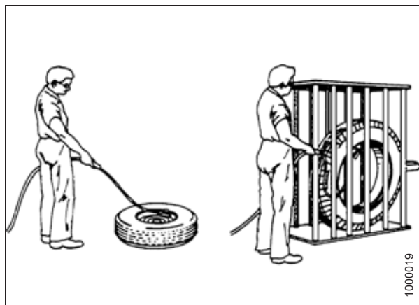
Рисунок 1.15: Безопасное накачивание шины
