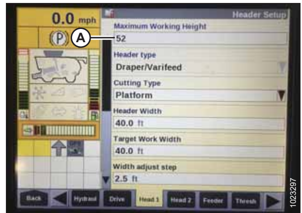
Рисунок 3.255: Дисплей комбайна Case: экран настройки жатки
