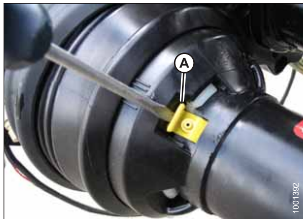
Рисунок 4.56: Защитный кожух кардана привода жатки
