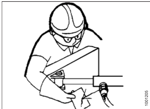
Рисунок 1.11: Проверка наличия гидравлических течей
