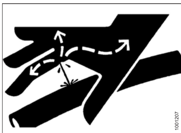
Рисунок 1.12: Опасное давление гидравлической жидкости
