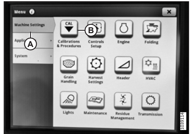
Рисунок 3.754: Дисплей John Deere — настройки машины
