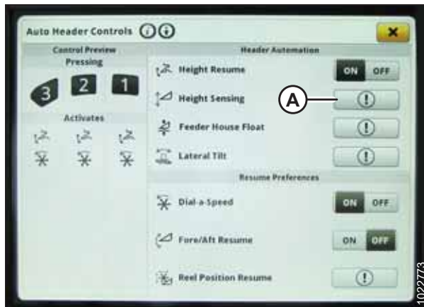
Рисунок 3.722: Дисплей John Deere S700 — элементы автоматического управления жаткой
