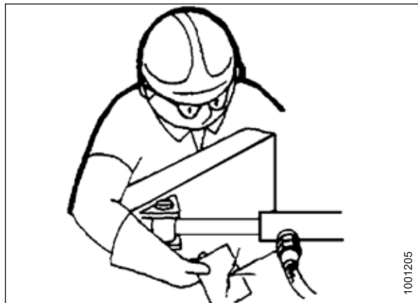
Рисунок 1.11: Проверка наличия гидравлических течей
