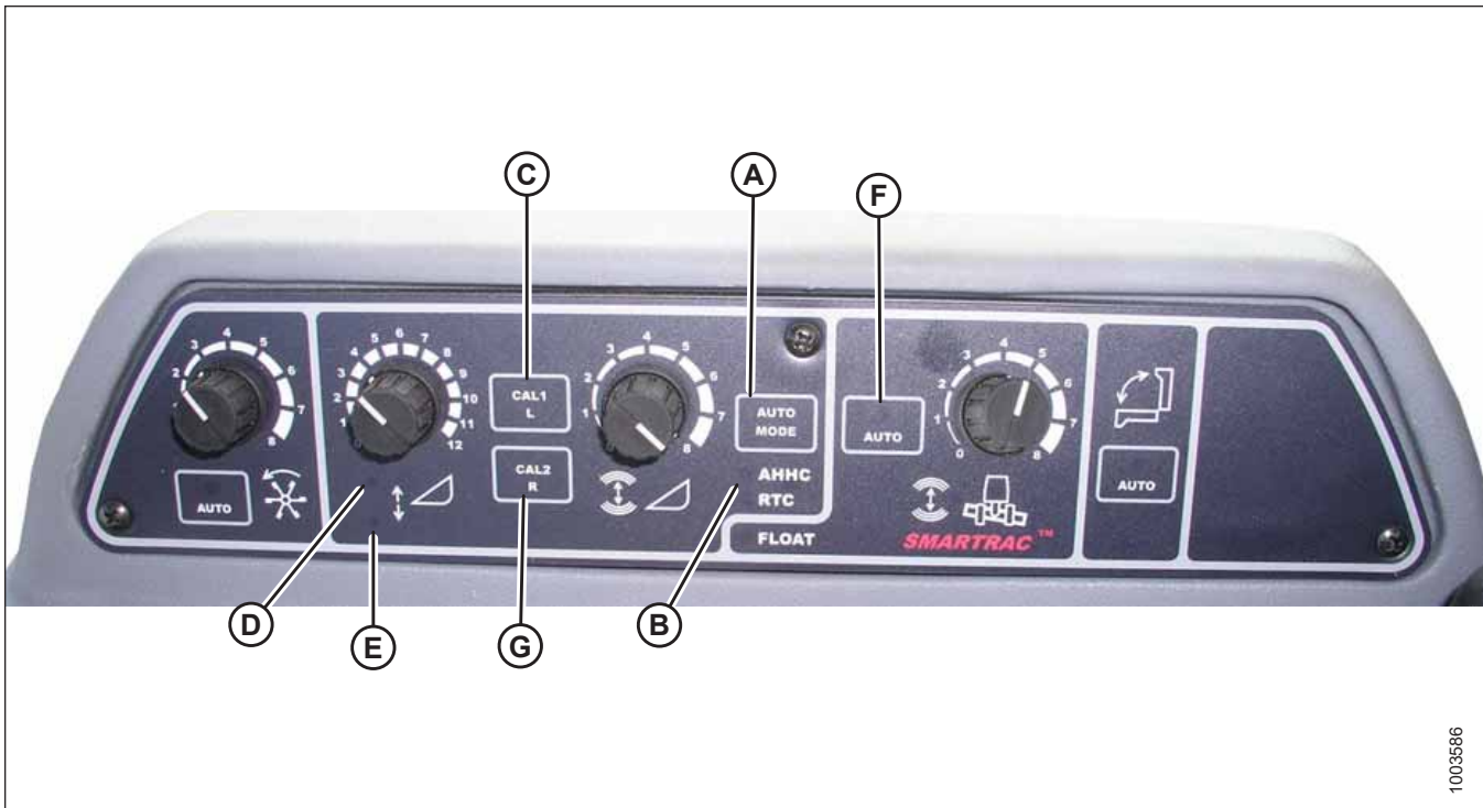
Рисунок 3.566: Органы управления автоматического контроля высоты жатки комбайна
