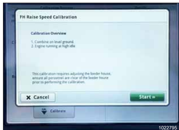
Рисунок 3.734: Дисплей John Deere S700 — калибровка наклонной камеры
