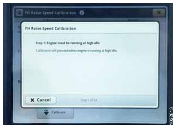
Рисунок 3.735: Дисплей John Deere S700 — калибровка наклонной камеры
