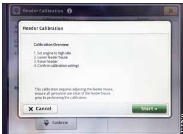
Рисунок 3.744: Дисплей John Deere S700 — калибровка жатки
