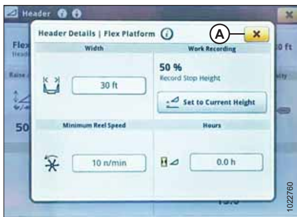
Рисунок 3.718: Дисплей John Deere S700 — диалоговое окно подробной информации о жатке
