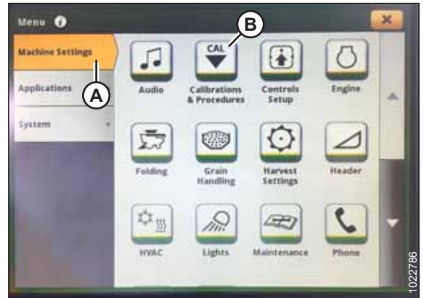
Рисунок 3.740: Дисплей John Deere S700 — настройки машины
