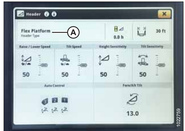
Рисунок 3.715: Дисплей John Deere S700 — страница Header (Жатка)
