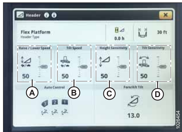
Рисунок 3.719: Дисплей John Deere S700 — страница Header (Жатка)
