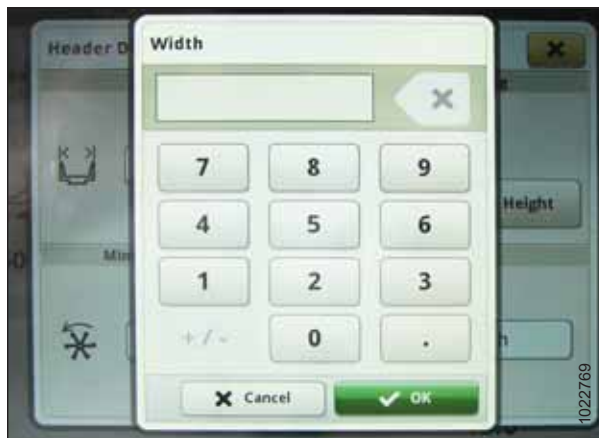
Рисунок 3.717: Дисплей John Deere S700 — настройка ширины жатки
