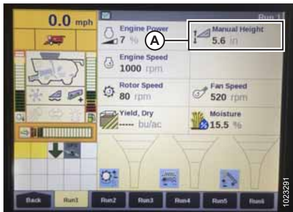
Рисунок 3.423: Дисплей комбайна Case — экран Run 1 (Работа 1)
