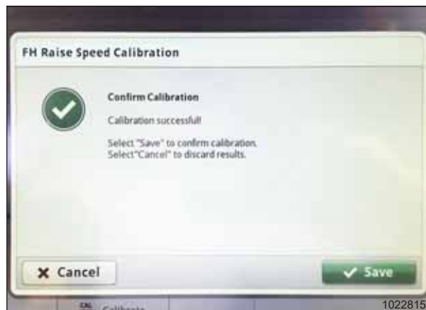
Рисунок 3.736: Дисплей John Deere S700 — калибровка наклонной камеры
