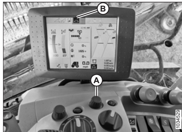
Рисунок 3.65: Значок скорости полотна на старых машинах CLAAS
