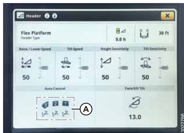
Рисунок 3.721: Дисплей John Deere S700 — страница Header (Жатка)
