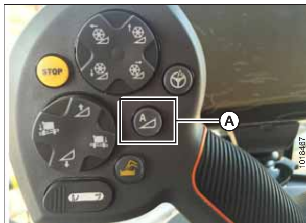
Рисунок 3.606: Автоматический контроль высоты жатки (АННС) на ручке управления
