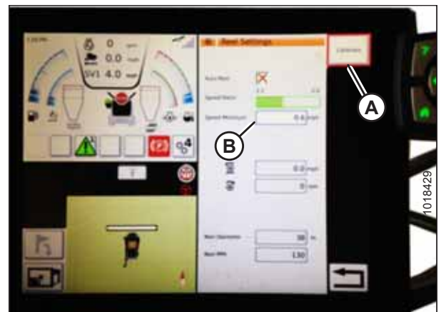
Рисунок 3.623: Калибровка параметров мотвила
