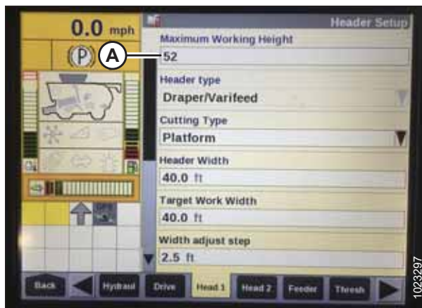
Рисунок 3.425: Дисплей комбайна Case: экран настройки жатки
