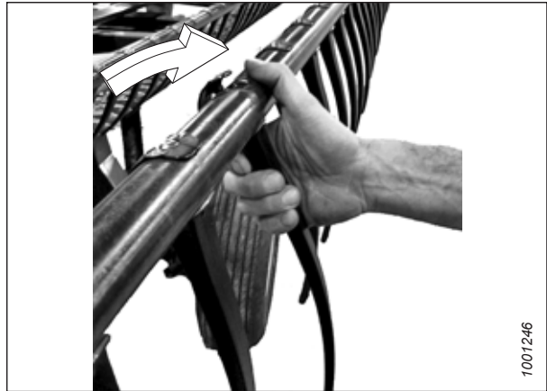
Figure 4.288: Installation des doigts en plastique
