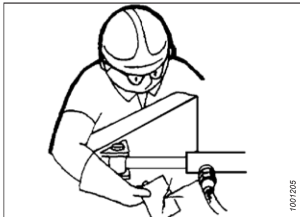
Рисунок 1.11: Проверка наличия гидравлических течей
