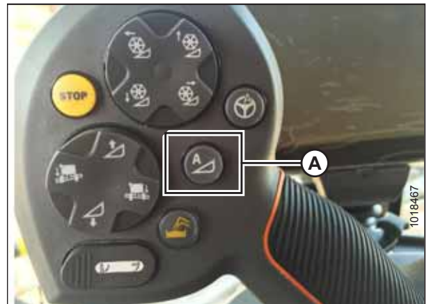
Рисунок 3.253: Автоматический контроль высоты жатки (АННС) на ручке управления
