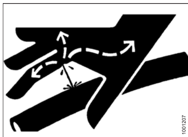
Рисунок 1.12: Опасное давление гидравлической жидкости
