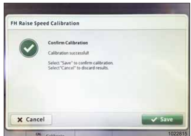
Рисунок 3.554: Дисплей John Deere S7 — калибровка наклонной камеры
