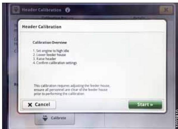
Рисунок 3.560: Дисплей John Deere S7 — калибровка жатки
