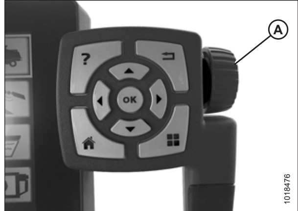
Рисунок 3.456: Регулировочное колесо на правой стороне терминала Tyton
