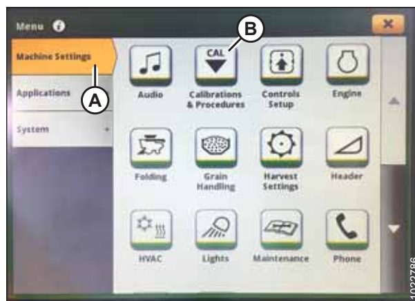
Рисунок 3.556: Дисплей John Deere S7 — настройки машины
