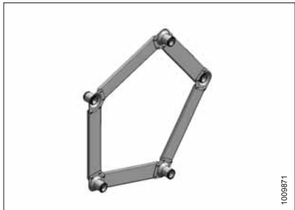
Рисунок 6.7: Показан комплект усиления на пять граблин, комплект усиления на шесть планок аналогичен
