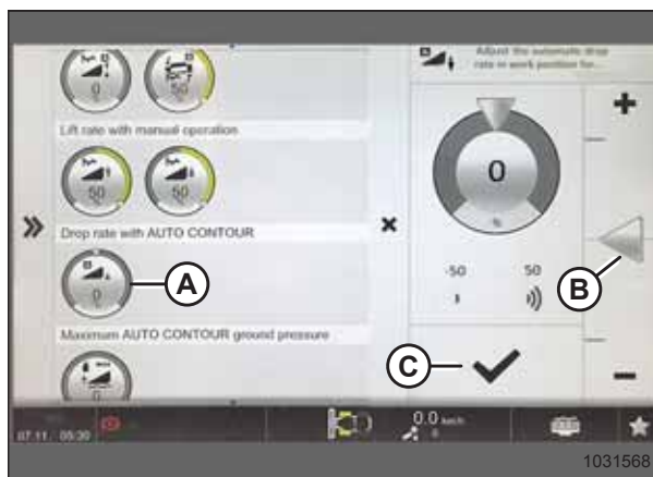
Рисунок 3.403: Страница скорости опускания с автоконтуром
