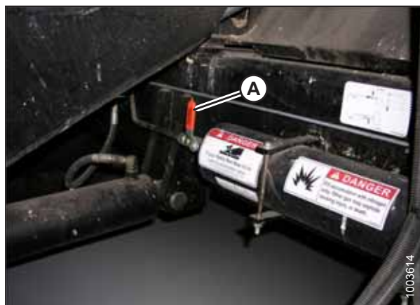
Рисунок 3.417: Выключатель гидроаккумулятора комбайна
