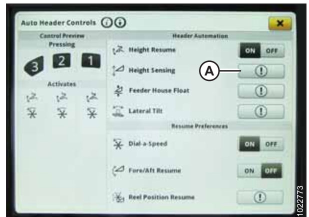
Рисунок 3.540: Дисплей John Deere S7 — автоматическое управление жаткой
