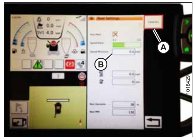
Рисунок 3.435: Калибровка параметров мотвила
