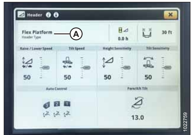
Рисунок 3.533: Дисплей комбайна John Deere серии S7 — страница жатки
