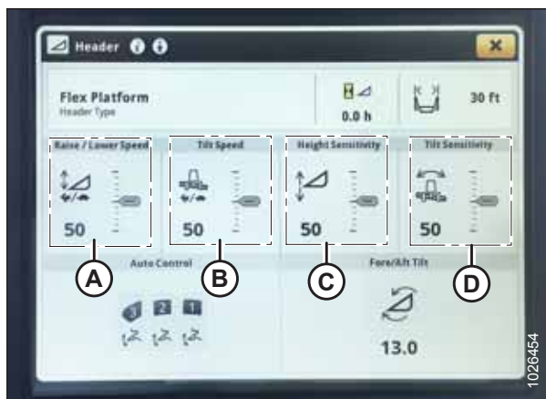
Рисунок 3.537: Дисплей комбайна John Deere серии S7 — страница жатки
