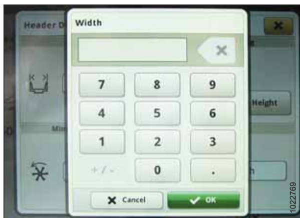
Рисунок 3.535: Дисплей John Deere S7 — настройка ширины жатки
