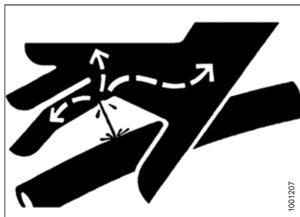
Рисунок 5.2: Опасное давление гидравлической жидкости
