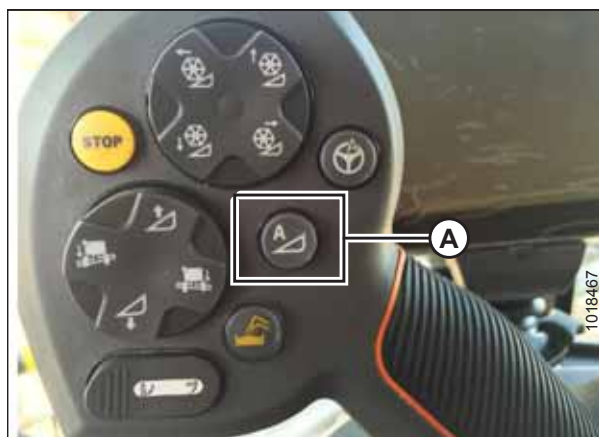
Рисунок 3.453: Автоматический контроль высоты жатки (АННС) на рукоятке управления
