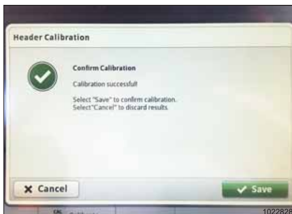
Рисунок 3.561: Дисплей John Deere S7 — калибровка жатки
