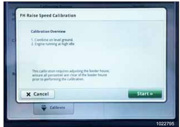
Рисунок 3.552: Дисплей John Deere S7 — калибровка наклонной камеры
