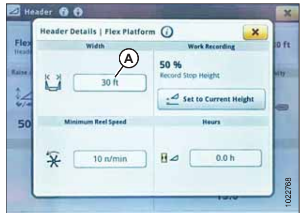
Рисунок 3.534: Дисплей комбайна John Deere серии S7: окно подробной информации о жатке
