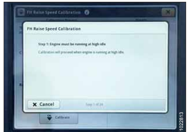
Рисунок 3.553: Дисплей John Deere S7 — калибровка наклонной камеры
