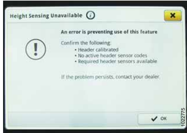
Рисунок 3.541: Дисплей John Deere S7 — сообщение об ошибке чувствительности по высоте
