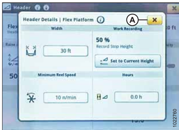
Рисунок 3.536: Дисплей комбайна John Deere серии S7: окно подробной информации о жатке
