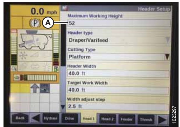
Рисунок 3.282: Дисплей комбайна Case: экран настройки жатки
