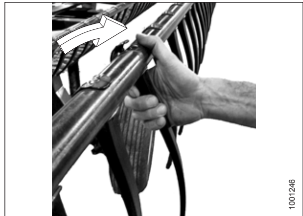
Attēls 5.169: Plastmasas pirksta uzstādīšana
