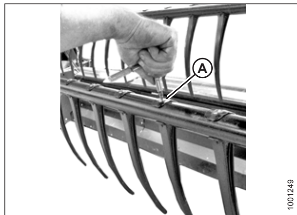
Attēls 5.170: Plastmasas pirksta uzstādīšana
