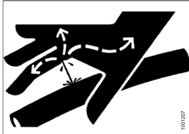
Abbildung 5.3: Gefährdung durch Hydraulikdruck
