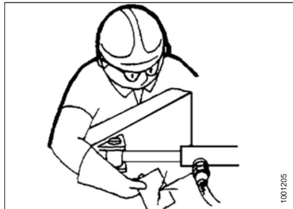
Abbildung 5.4: Suche nach undichten Hydraulikstellen
