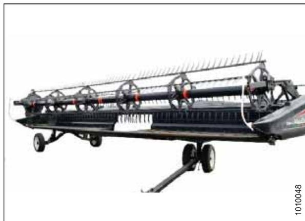
Abbildung 6.15: Tasträder und integrierte Transporteinrichtung
