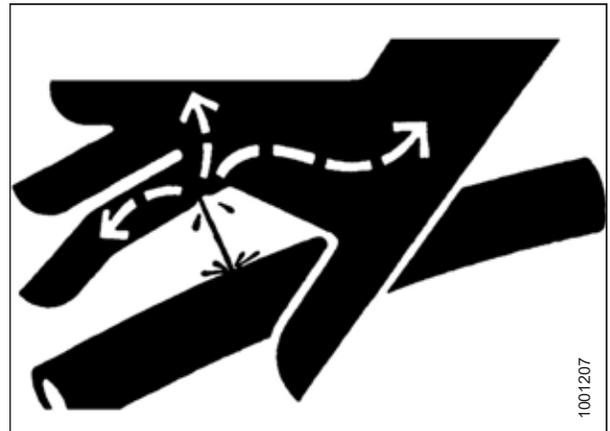
Abbildung 1.12: Gefährdung durch Hydraulikdruck
