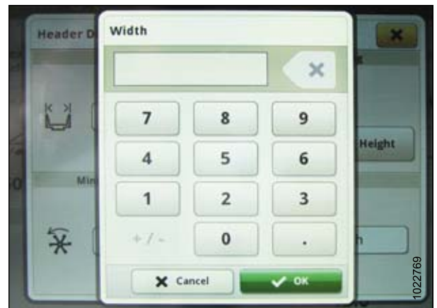
Рисунок 3.386: Дисплей John Deere S7 — установка ширины жатки
