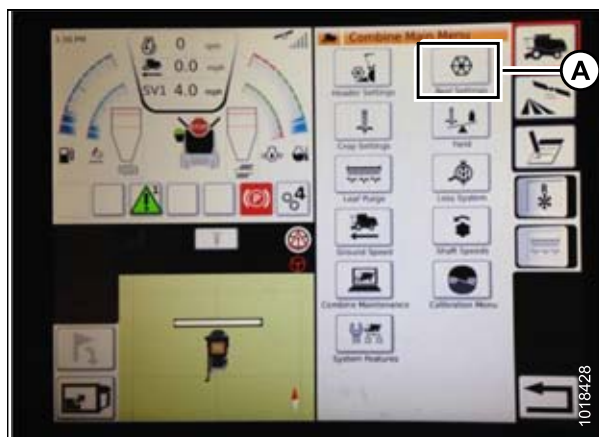
Рисунок 3.289: Настройки мотовила в главном меню комбайна
