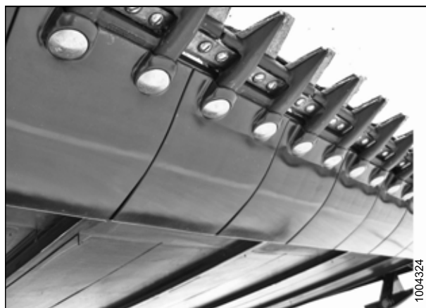
Рисунок 6.7: Противоизносные пластины ножевого бруса
