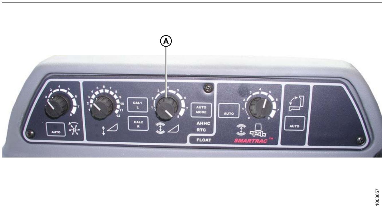
Рисунок 3.276: Консоль автоматического контроля высоты жатки
