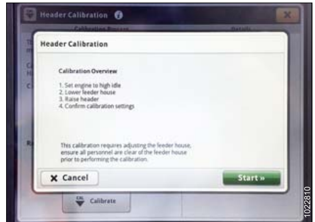
Рисунок 3.411: Дисплей John Deere S7 — калибровка жатки
