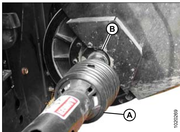
Рисунок 4.32: Отсоединение кардана привода жатки
