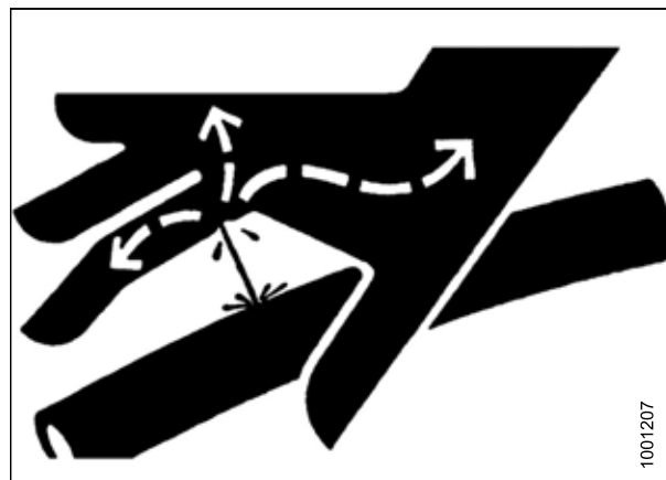
Рисунок 5.2: Опасное давление гидравлической жидкости
