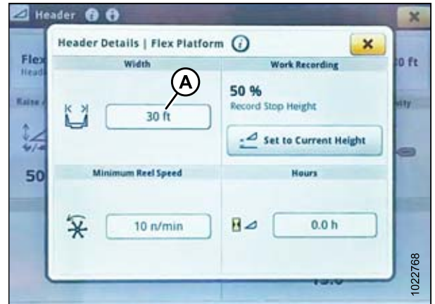
Рисунок 3.385: Дисплей комбайна John Deere серии S7 — окно подробной информации о жатке
