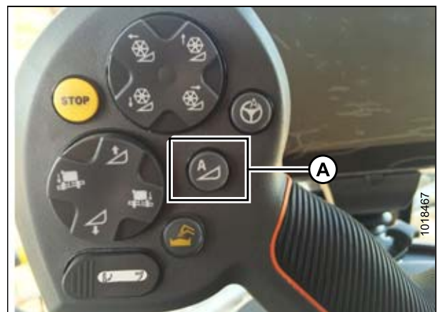
Рисунок 3.308: Автоматический контроль высоты жатки (Автоконтур) на ручке управления
