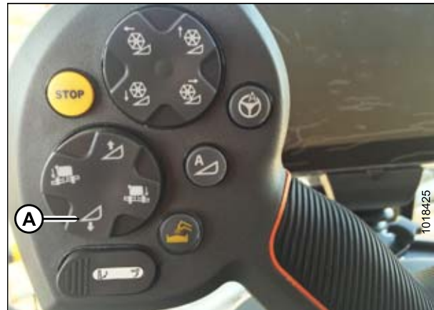
Рисунок 3.300: Кнопка опускания жатки
