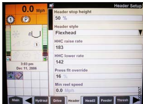
Рисунок 3.231: Приборная панель комбайна Case IH
