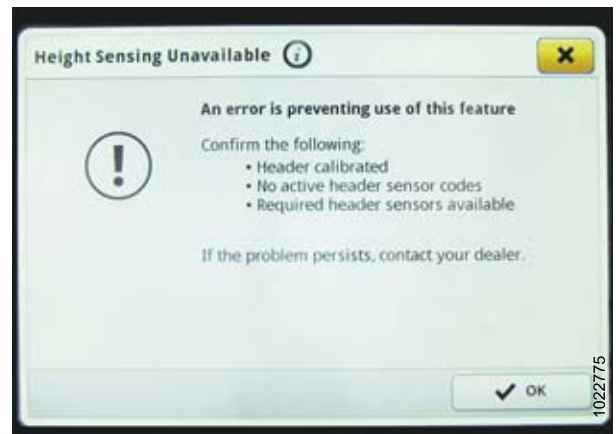
Рисунок 3.392: Дисплей John Deere S7 — сообщение об ошибке чувствительности по высоте
