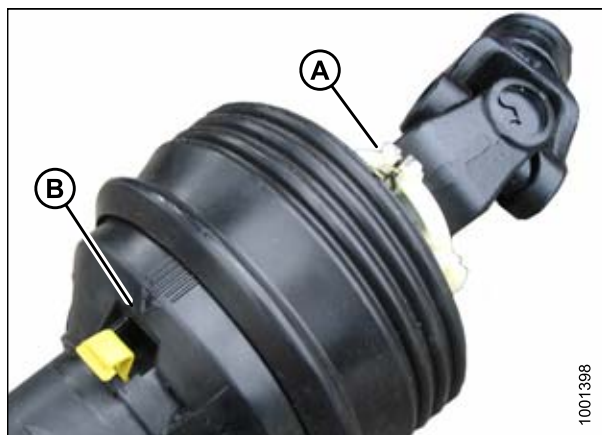
Рисунок 5.41: Кожух кардана привода жатки
