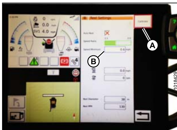
Рисунок 3.290: Калибровка настроек мотовила
