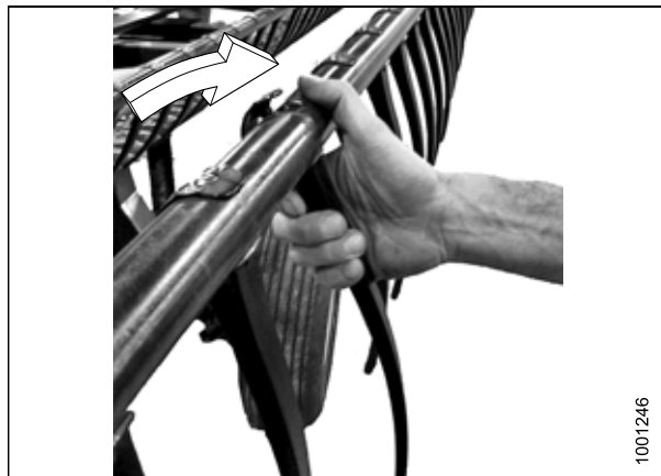
Рисунок 5.252: Установка пластмассового пальца
