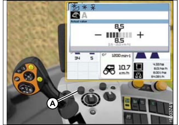
Рисунок 3.446: Дисплей, консоль и ручка управления комбайна CLAAS
