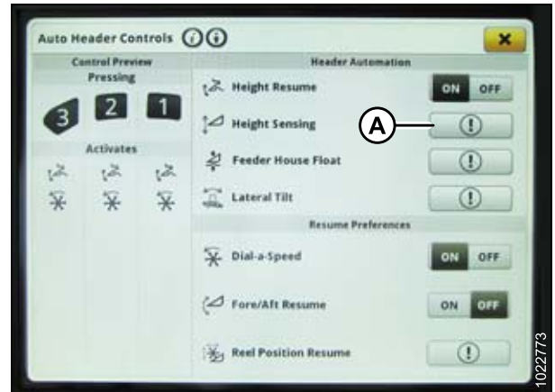
Рисунок 3.391: Дисплей John Deere S7 — автоматический контроль параметров жатки
