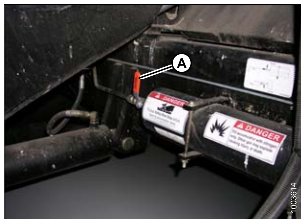
Рисунок 3.272: Выключатель гидроаккумулятора комбайна
