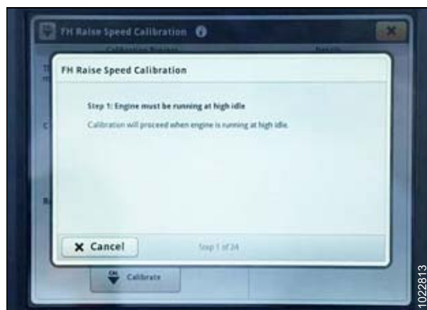
Рисунок 3.404: Дисплей John Deere S7 — калибровка наклонной камеры
