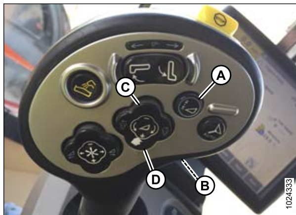
Рисунок 3.248: Органы управления комбайна Case
