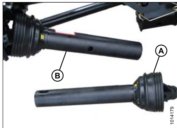
Рисунок 5.38: Раздельный кардан привода жатки
