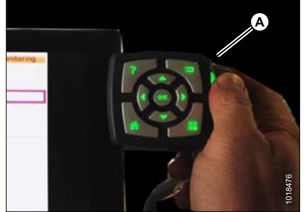
Рисунок 3.311: Регулировочное колесо на правой стороне терминала Tyton
