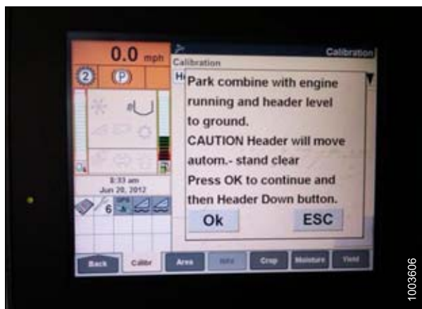
Рисунок 3.242: Приборная панель комбайна Case IH
