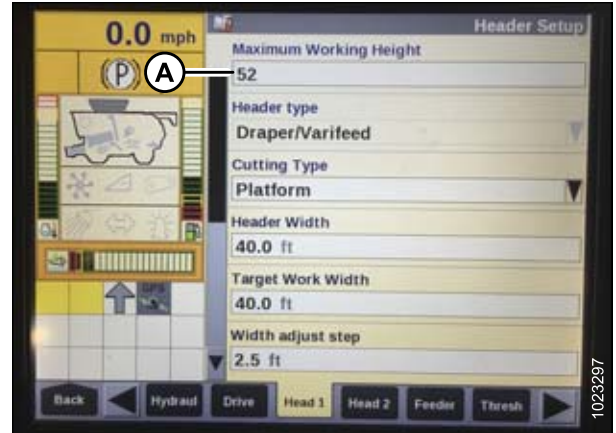
Рисунок 3.214: Дисплей комбайна Case — экран настройки жатки
