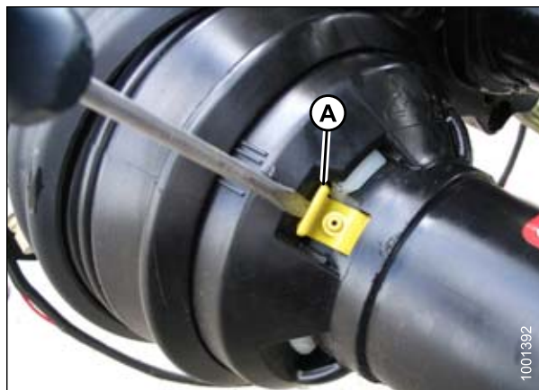
Рисунок 5.39: Кожух кардана привода жатки
