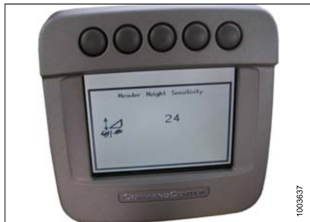
Рисунок 3.336: Дисплей комбайна John Deere
