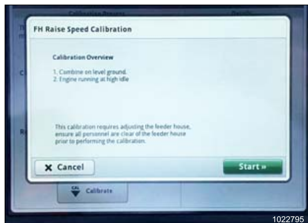
Рисунок 3.403: Дисплей John Deere S7 — калибровка наклонной камеры
