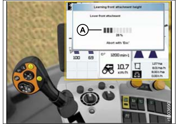
Рисунок 3.437: Дисплей, консоль и ручка управления комбайна CLAAS
