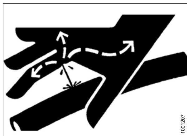
Рисунок 1.12: Опасное давление гидравлической жидкости
