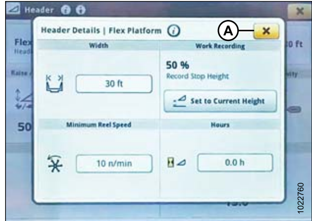
Рисунок 3.387: Дисплей комбайна John Deere серии S7 — окно подробной информации о жатке
