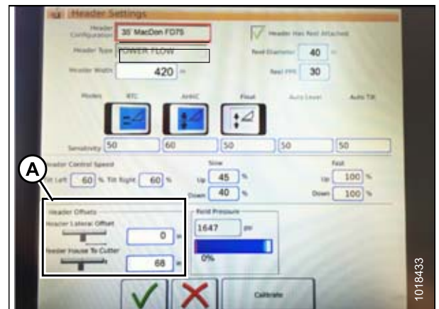
Рисунок 3.295: Настройки сдвига жатки
