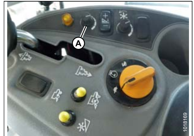
Рисунок 3.260: Ручка регулировки высоты на консоли управления комбайна
