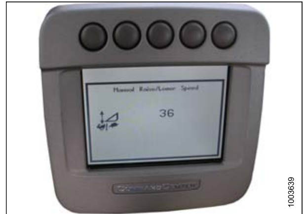
Рисунок 3.338: Дисплей комбайна John Deere
