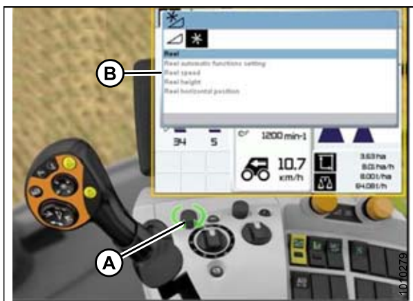
Рисунок 3.444: Дисплей, консоль и ручка управления комбайна CLAAS
