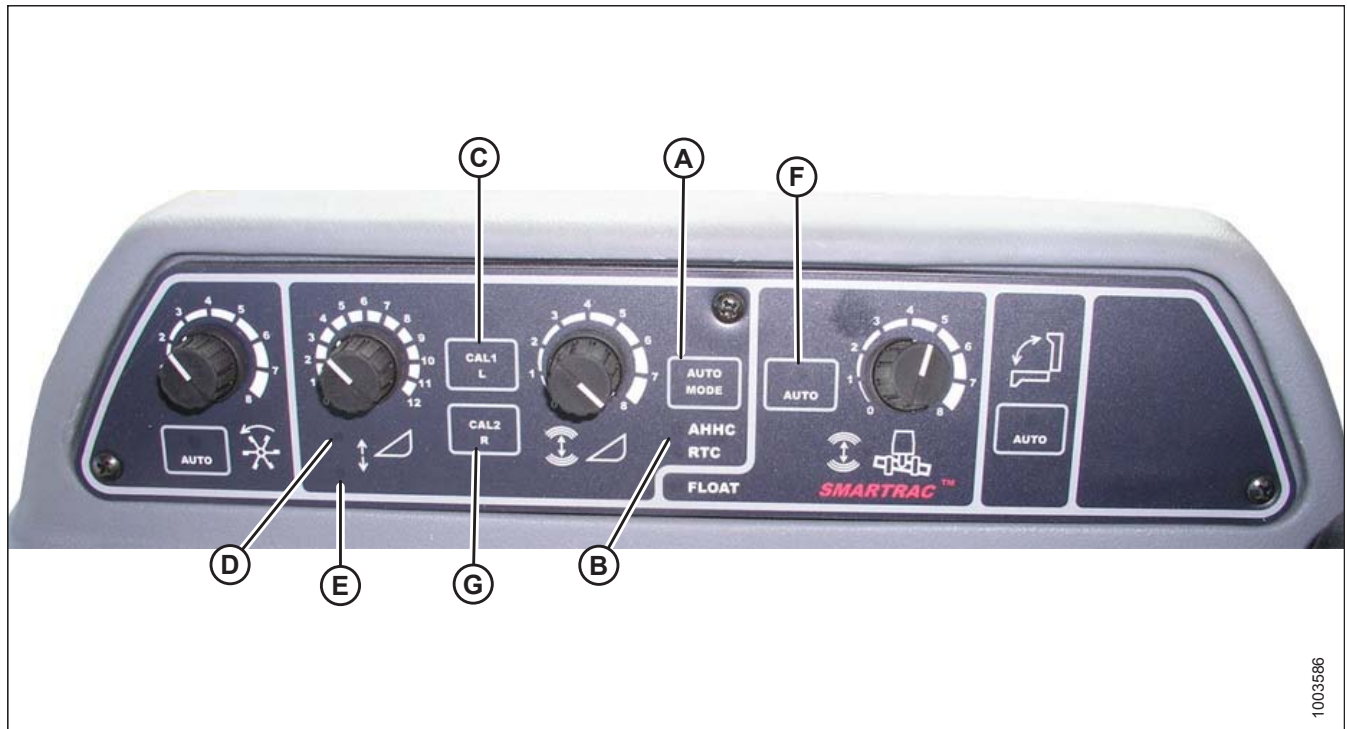
Figure 3.271: Commandes du système de réglage automatique de la hauteur de la plateforme de la moissonneuse-batteuse
