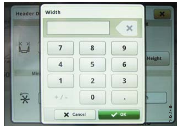
Figure 3.386: Écran John Deere S7 - Réglage de la largeur de la plateforme
