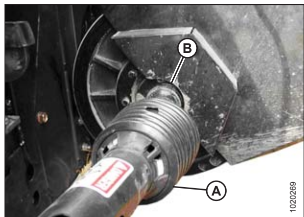
Figure 4.32: Déconnectez la transmission
