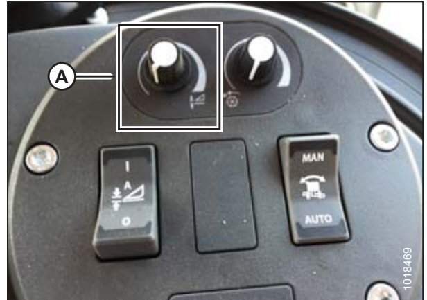
Figure 3.309: Groupe de commande de la plateforme
