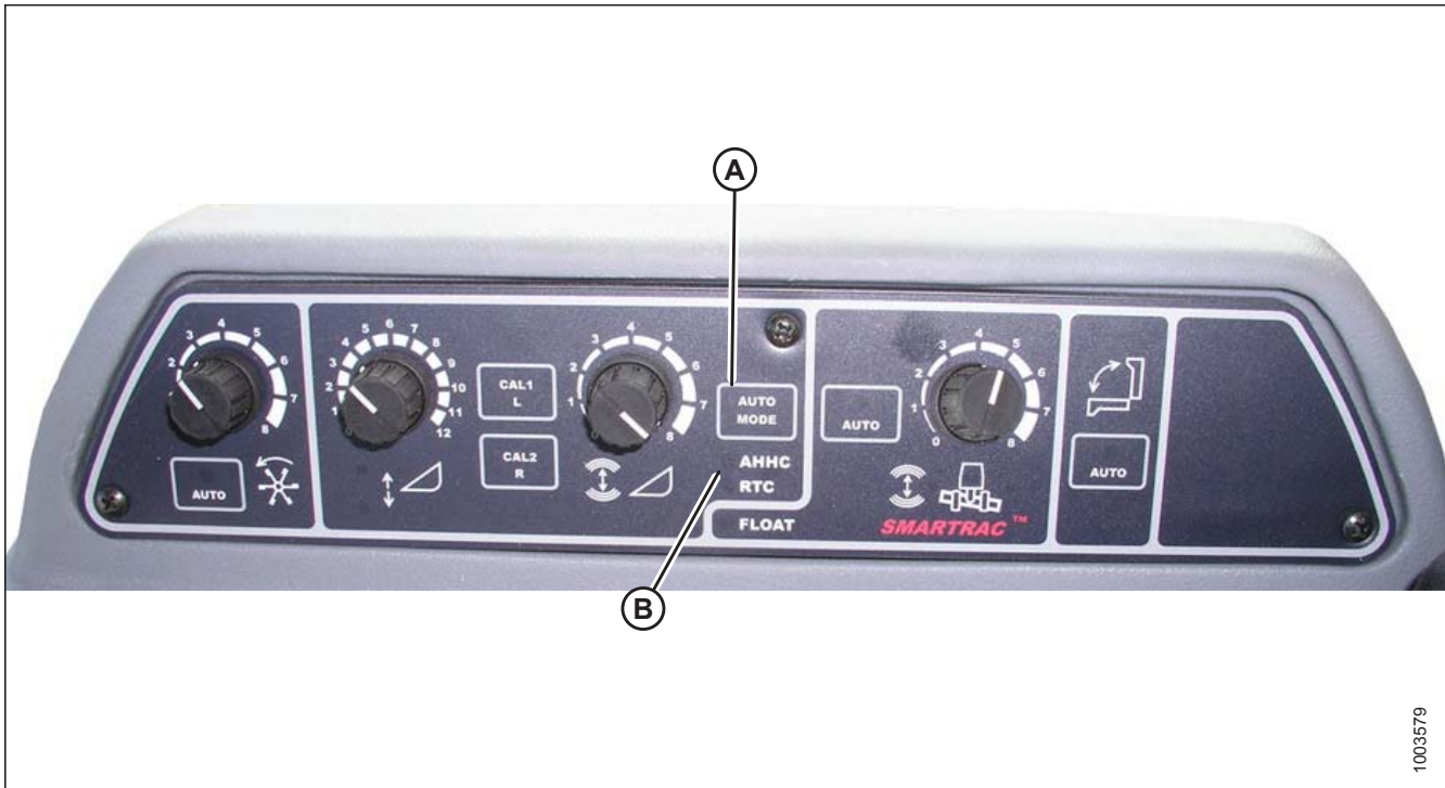
Figure 3.269: Commandes du système de réglage automatique de la hauteur de la plateforme de la moissonneuse-batteuse
