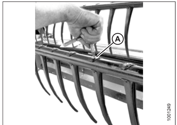
Figure 5.253: Installation des doigts en plastique
