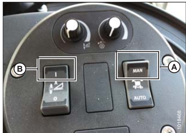
Figure 3.307: Groupe de commande de la plateforme
