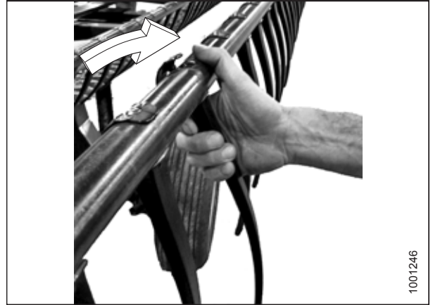
Figure 5.252: Installation des doigts en plastique
