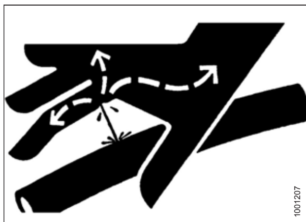
Figure 1.12: Risque lié à la pression hydraulique
