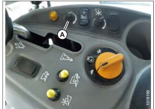
Figure 3.260: Bouton de réglage de la hauteur sur la console de commande de la moissonneuse-batteuse
