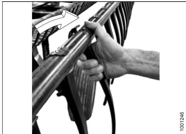
Figure 5.252: Installation des doigts en plastique
