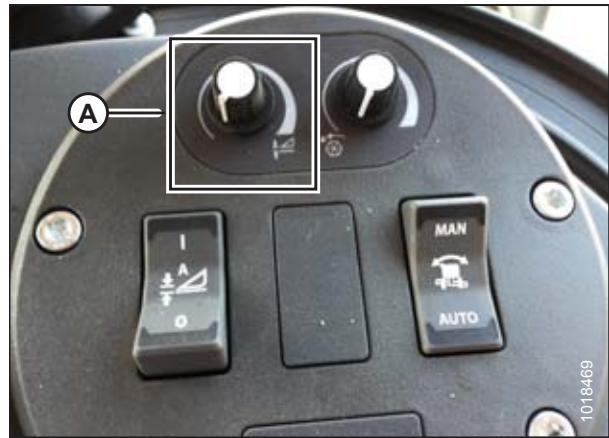
Figure 3.312: Groupe de commande de la plateforme
