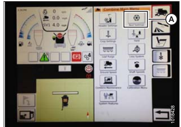
Figure 3.289: Paramètres du rabatteur dans le menu principal de la moissonneuse-batteuse
