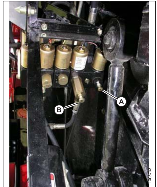
Figure 3.273: Limiteurs réglables d'élévation et d'abaissement de la plateforme
