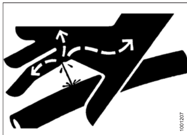
Figure 5.2: Risque lié à la pression hydraulique
