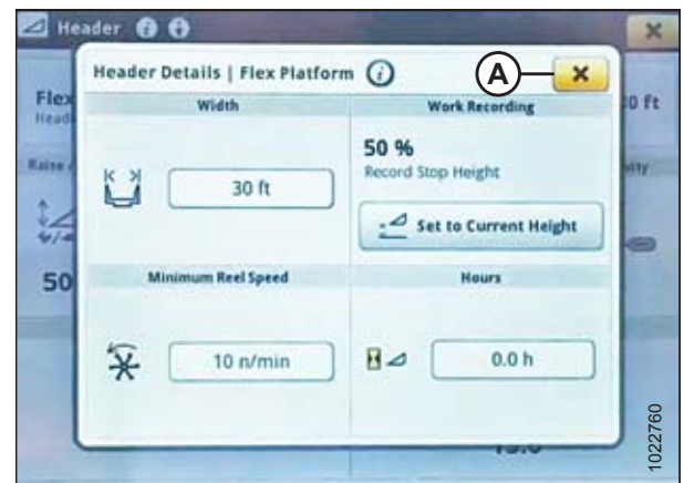
Figure 3.387: Écran John Deere S7 - Fenêtre Détails de la plateforme
