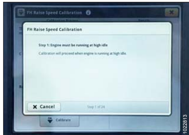
Figure 3.404: Écran John Deere S7 - Étalonnage du convoyeur
