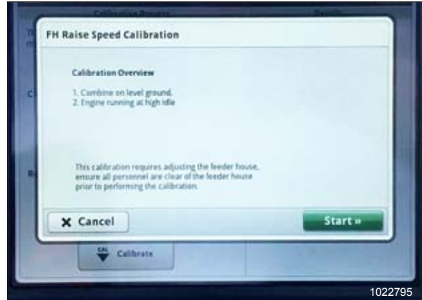
Figure 3.403: Écran John Deere S7 - Étalonnage du convoyeur
