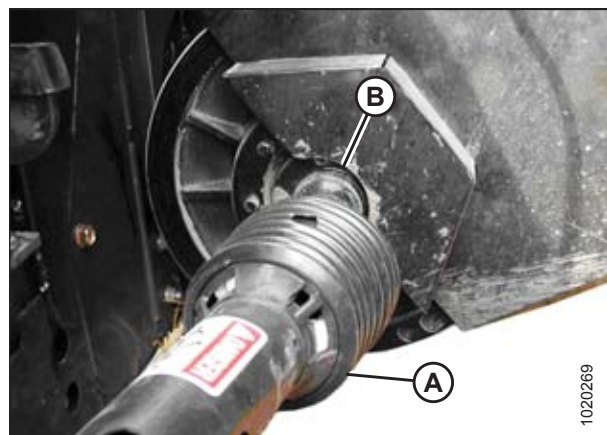
Figure 4.32: Déconnectez la transmission
