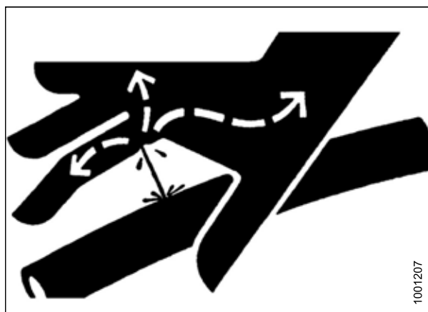
Рисунок 5.3: Опасное давление гидравлической жидкости
