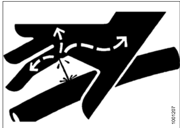
Рисунок 1.12: Опасное давление гидравлической жидкости
