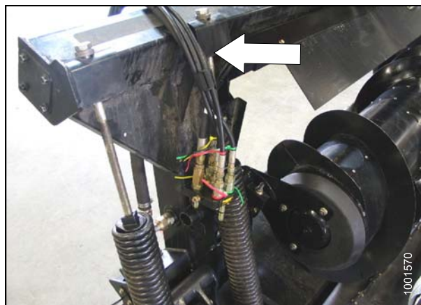
Figure 5.129: Rangez et fixez les flexibles
