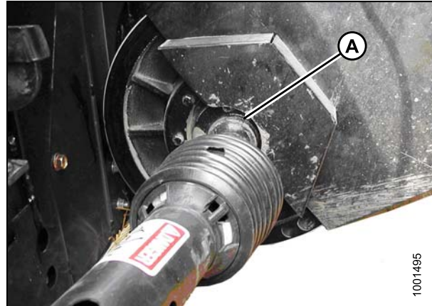
Figure 5.110: Déconnectez l'arbre de transmission
