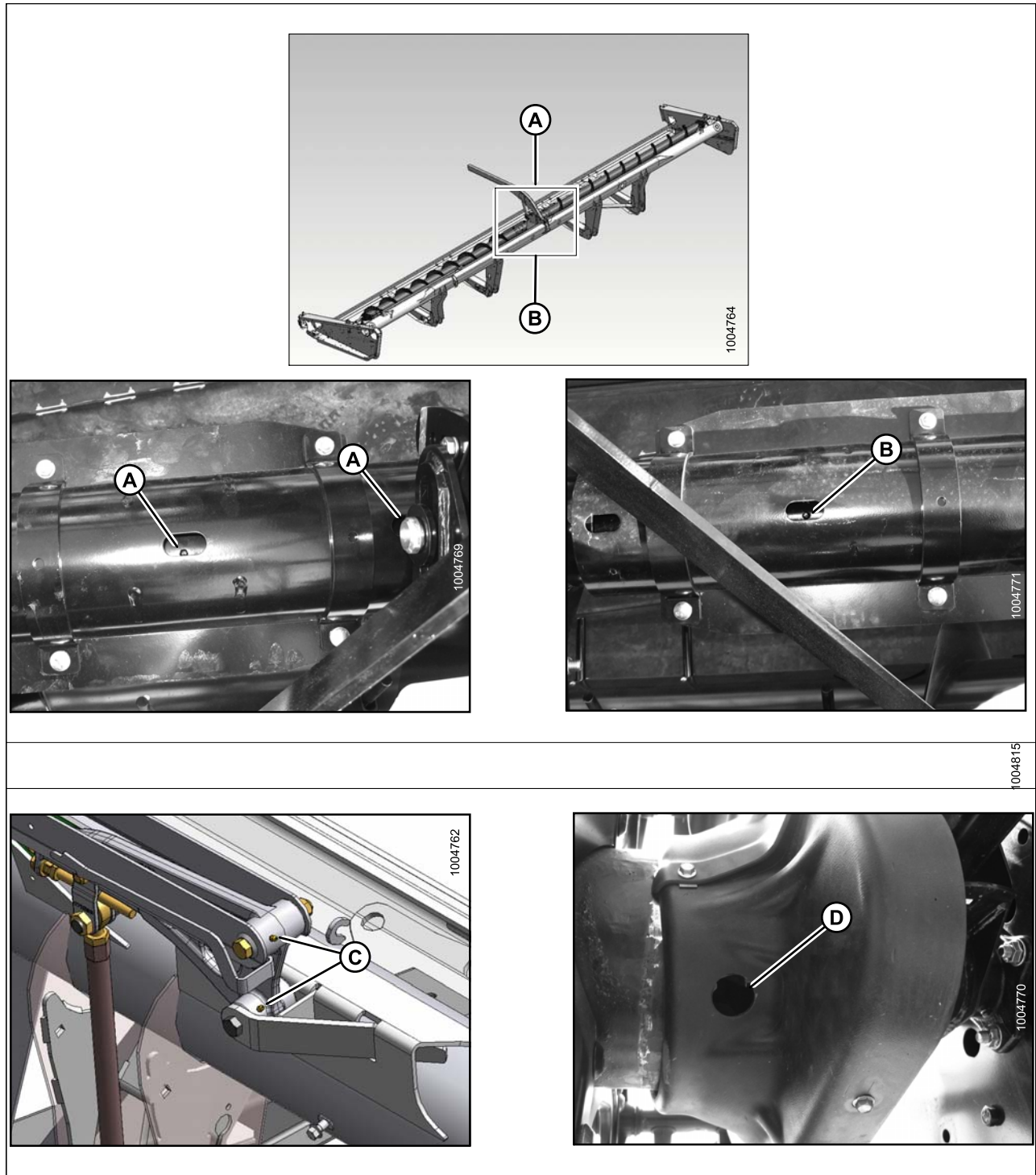
Figure 7.11: Toutes les 250 heures - Utilisez Performance pression extrême haute température (EP2) avec 1% max. de bisulfure de molybdène (grade NLGI Grade 2) À base de lithium
