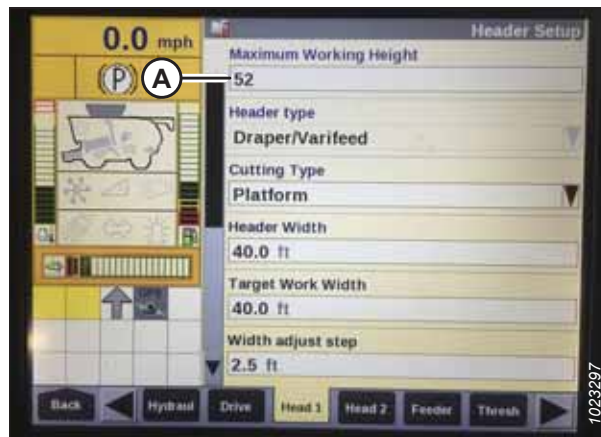
Figure 3.321: Case kombaina displejs — hedera iestatīšanas lapa
