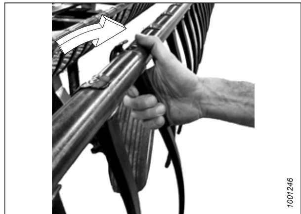
Figure 4.294: Plastmasas pirksta uzstādīšana
