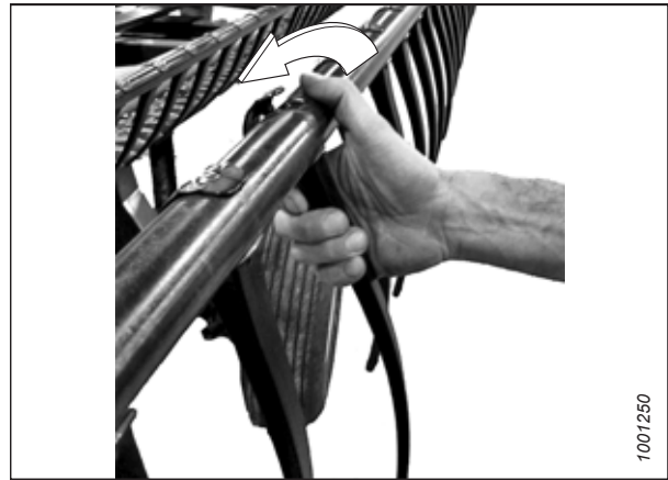
Figure 4.293: Plastmasas pirksta noņemšana
