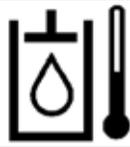
При температуре ниже 10 градусов С, прежде чем эксплуатировать на полной нагрузке, поработайте жаткой на холостом ходу 5 минут.
