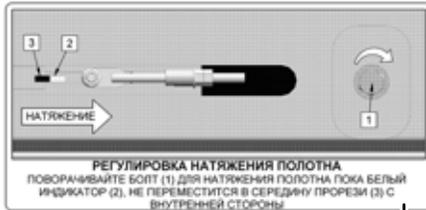
**РЕГУЛИРОВКА НАТЯЖЕНИЯ ПОЛОТНА**
