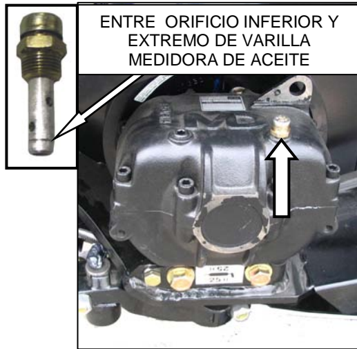
CAJA MANDO CUCHILLA (VERIFIQUE NIVEL DE ACEITE CON LA TAPA DE CAJA DE MANDO CUCHILLA HORIZONTAL)
